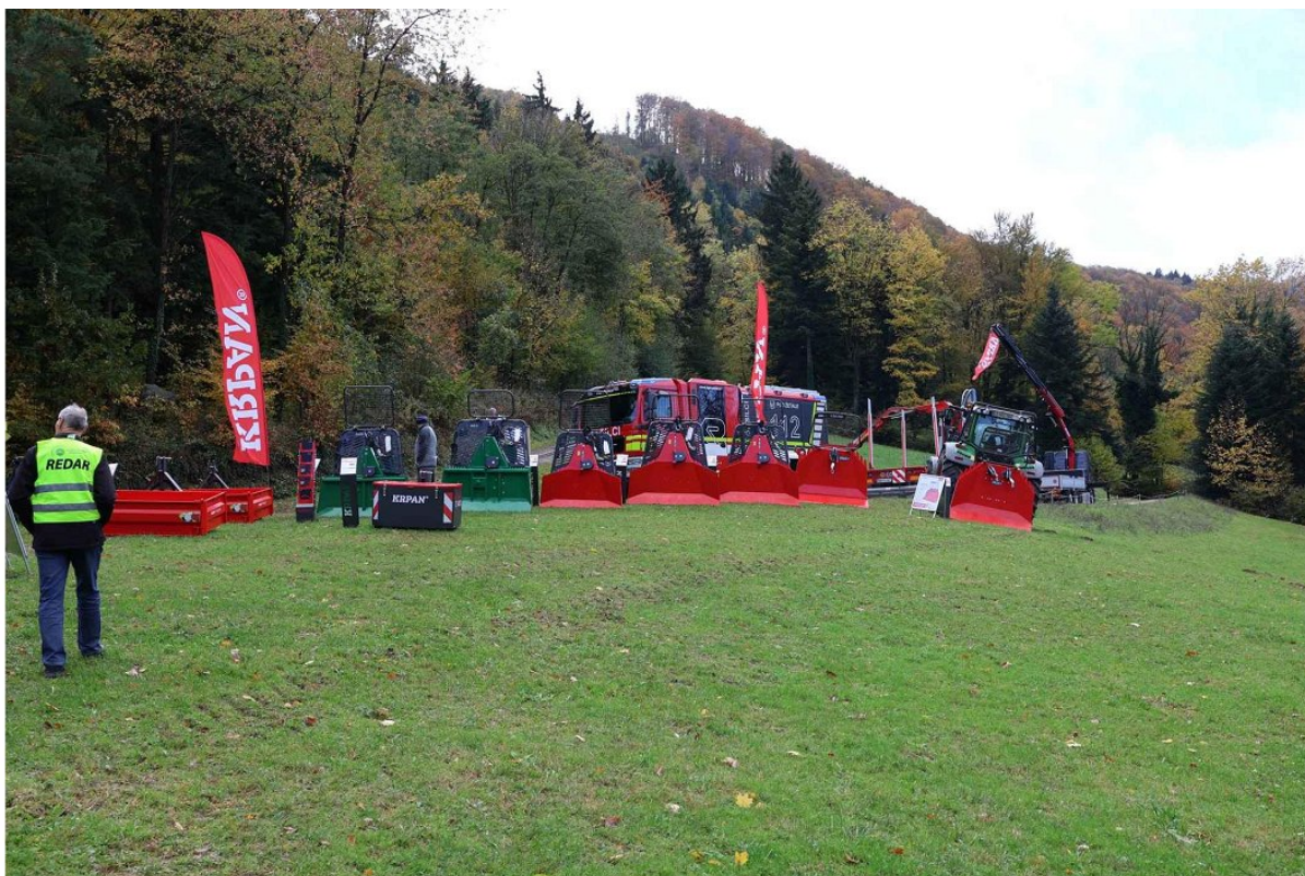
Slika 1: Paleta tritočkovno nošenih gozdarskih vitlov KRPAN: od linije Greenline na levi, novih verižno gnanih na sredni in zobniško gnanih vitlov s konstantno vlečno silo na desni.
