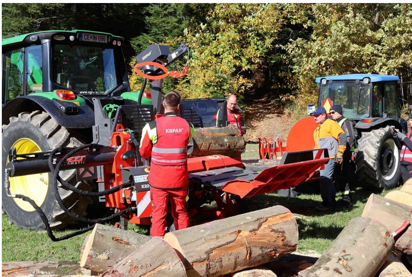
Slika 4: Horizontalni cepilnik in povezovalnik drv. Cepilnik je opremljen z vitlom za privleko lesa.
