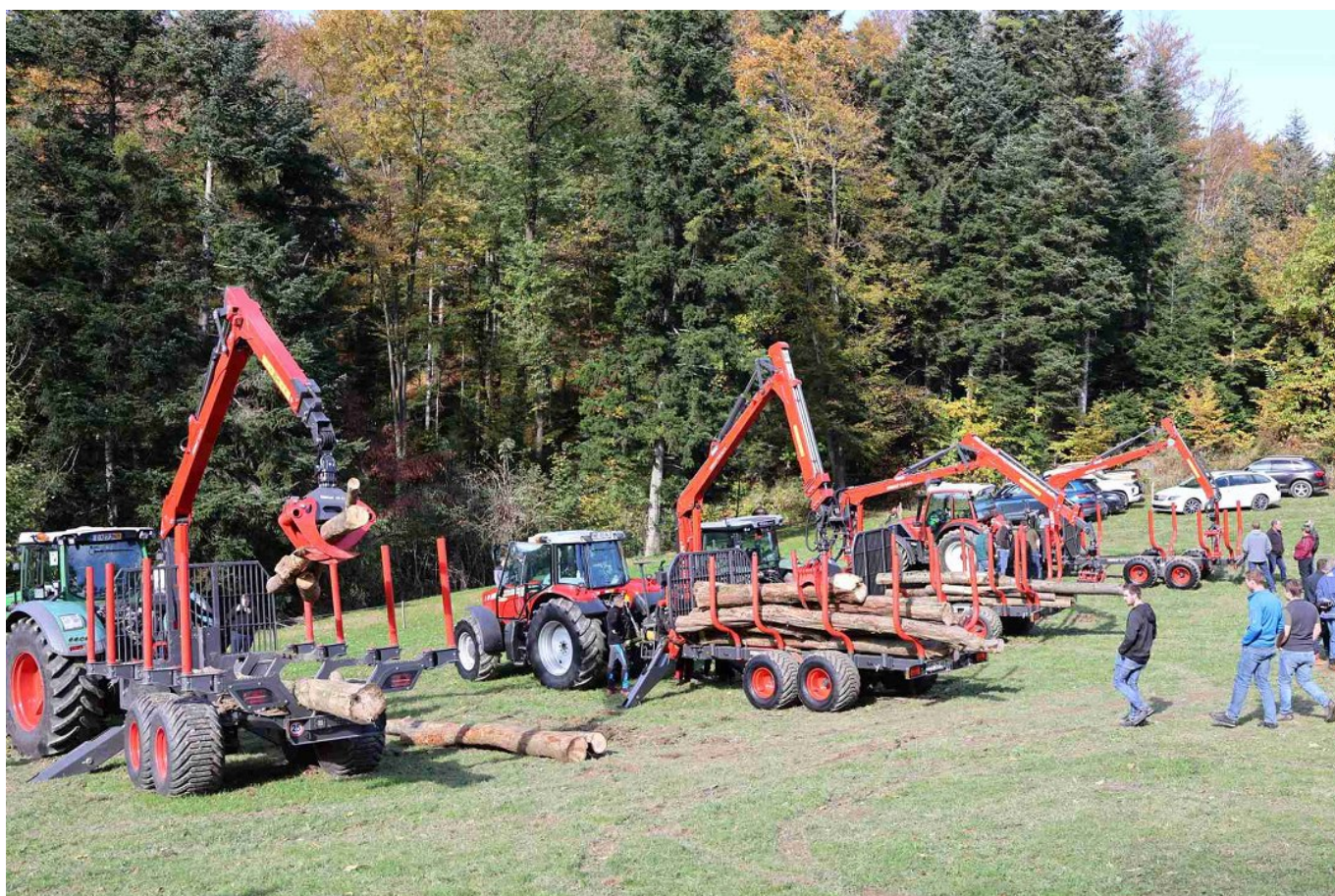
Slika 3: Prototip nove gozdarske prikolicе z enotno nosilno osnovo (»unibody«) na levi in nova lahka prikolica z enocevno nosilno osnovo na desni, vmes pa uveljavljene dvocevne izvedbe.
