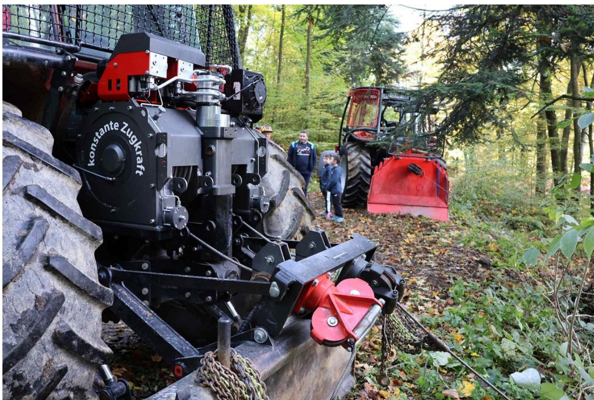
Slika 2: Vgradni dvobobenski vitel in novi enobobenski vitel KRPAN, oba z zobniškim pogonom in konstantno vlečno silo.
