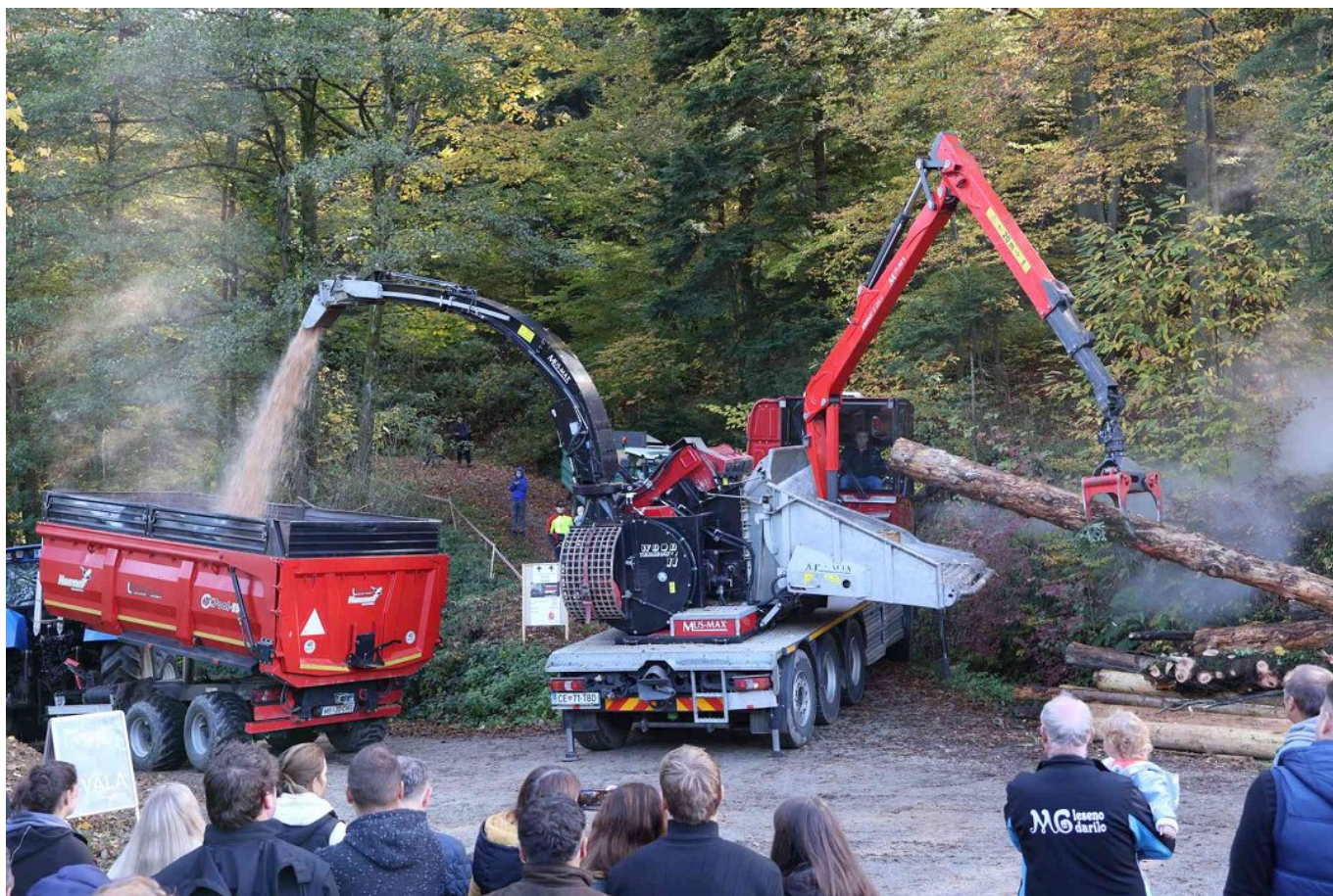
Slika 6: Podjetje Biomasa Bučer je v Žetalah prikazalo pripravo sekancev z enim od njihovih kompletov kamionskih sekalnikov, ki so opremljeni s kamionskimi gozdarskimi dvigali KRPA.
