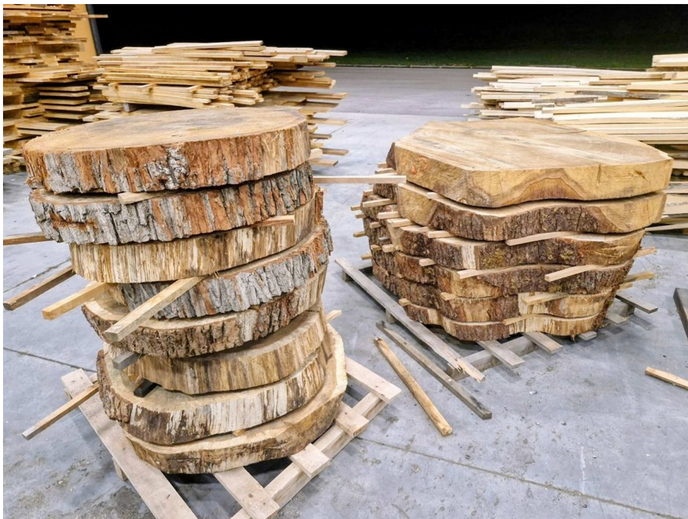
Slika 5: Sušenje hrastovih panjev v tehnoloških prostorih CEKOM (fotografija: M. Dovečar, Gozdarski inštitut Slovenije)
