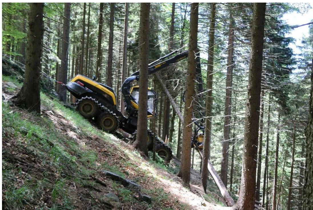
Slika 46: Moderna gozdarska mehanizacija omogoča varno in ekološko sprejemljivo delovanje na vse višjih naklonih. Vendar je prisotnost take mehanizacije v Sloveniji še zelo redka. (foto: M. Dolenšek)
