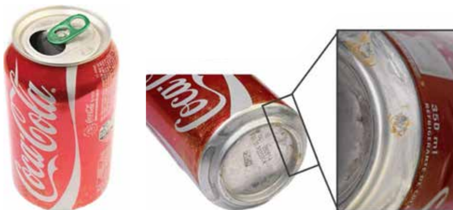
Slika 5a: Področja kjer je prišlo do perforacije in iztekanja tekočine.
