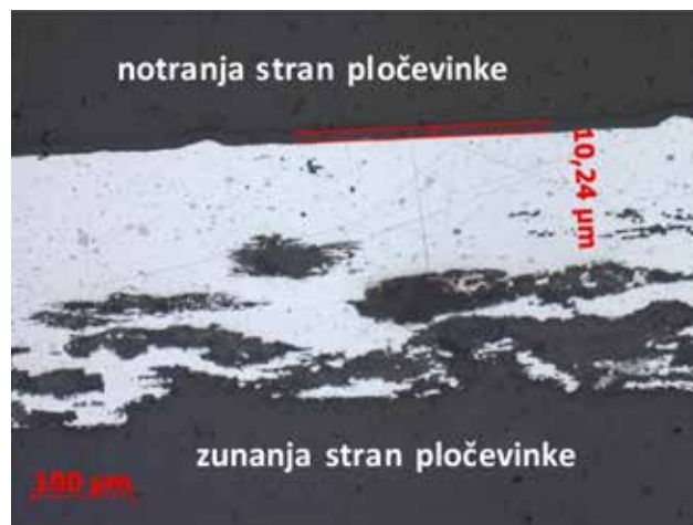
Slika 5c in 5d: Korozija na zunanji strani pločevinke. Na notranji strani pločevinke je lak debeline 10 mm.
