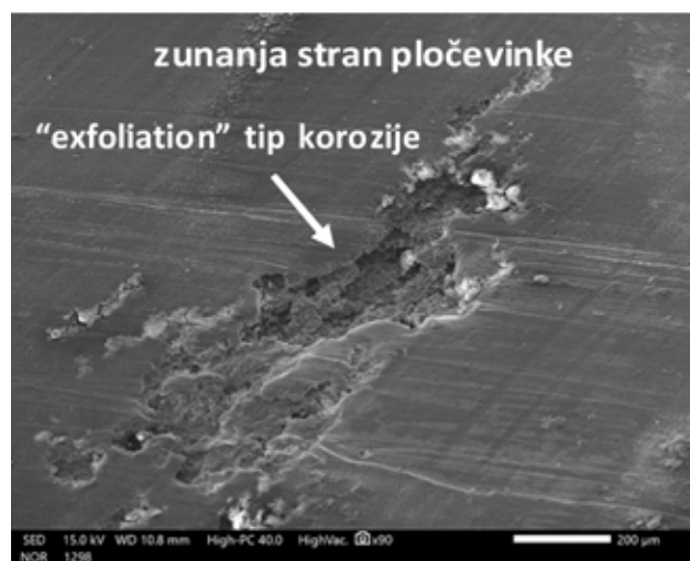
Slika 5e in 5f: Razpoka na notranji strani pločevinke. Zunanja stran pločevinke: “exfoliation” tip korozije.
