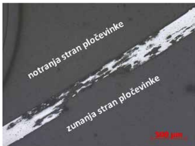
Slika 5c in 5d: Korozija na zunanji strani pločevinke. Na notranji strani pločevinke je lak debeline 10 mm.
