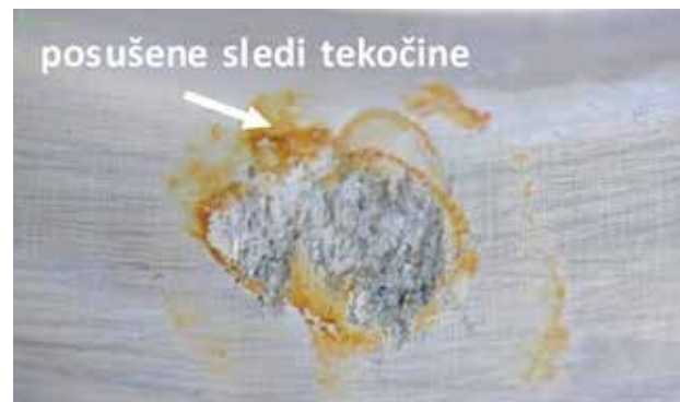
Slika 5b: Korozijska na zunanjem delu pločevinke in posušene sledi tekočine (rumeno - rjavo).
