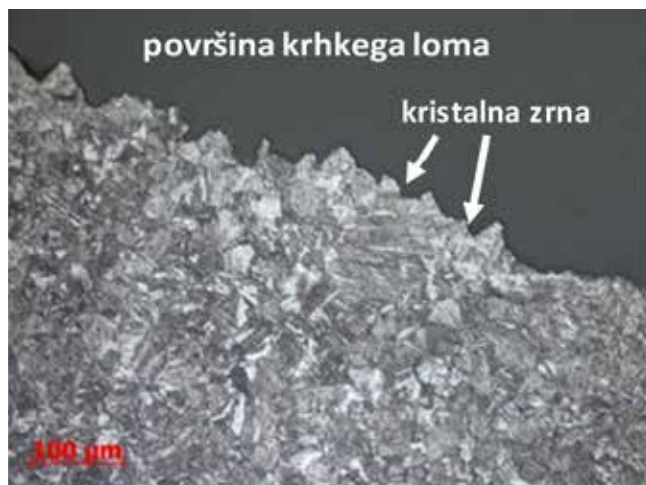
Slika 4d: Lomna površina krhkega loma poteka po kristalnih zrnih.
