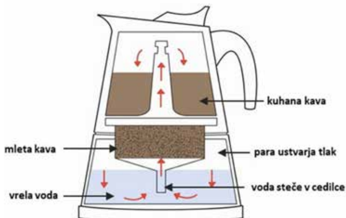
Slika 2a in 2b: Razpoka na spodnjem delu kafetiere iz nerjavnega jekla ter shema delovanja kafetiere.
