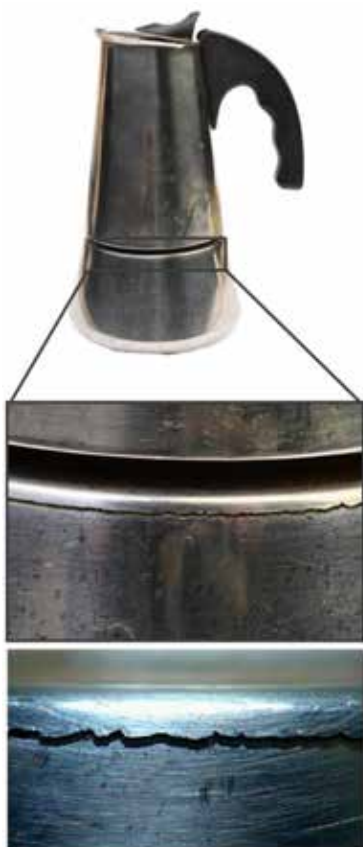
Slika 2a in 2b: Razpoka na spodnjem delu kafetiere iz nerjavnega jekla ter shema delovanja kafetiere.
