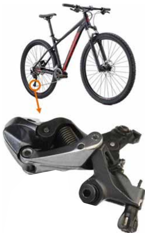
Slika 3a: Prelom nosilca zadnjega menjalnika iz aluminija.
