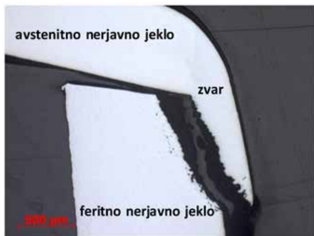
Slika 2c: Razpoka med posodo za vodo ter navojnim delom na spodnjem delu kafetiere iz nerjavnega jekla pri večji povečavi. Stik med zgornjim navojnim delom ter spodnjo posodo za vodo je prevarjen samo na približno \frac{1}{4} celotne stične površine.
