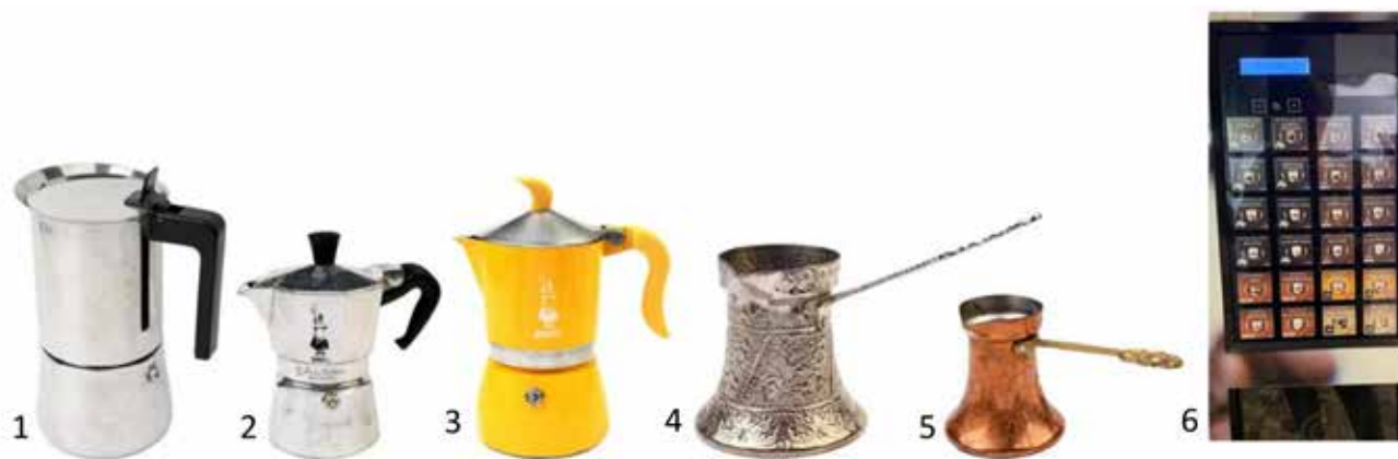
Slika 2g: Različni načini priprave napitka kave za analizo (1-kafetjera iz nerjavnega jekla, 2-kafetjera iz aluminija, 3-rumena kafetjera (Al), 4-velika džezva, 5-mala džezva, 6-kavni aparat).
