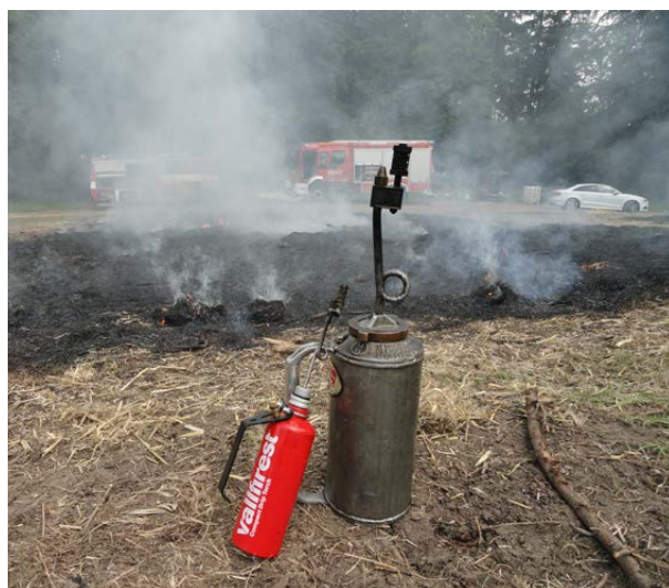
Slika 5: Netilna bakla (drip torch) je namenjena preventivni in operativni rabi na intervencijah. (arhiv: J. Saražin)
