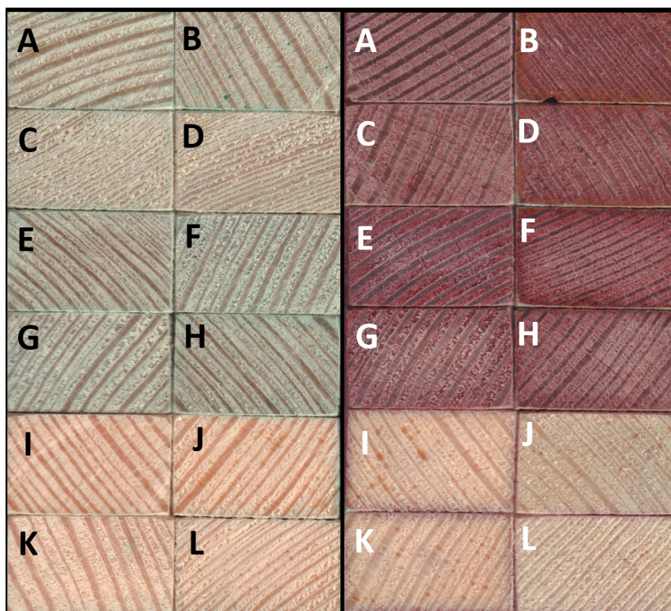
Slika 1: Prečni prerezi vzorcev, tretiranih z različnimi zaščitnimi pripravki in njihovimi kombinacijami (levo A – L). Prečni prerezi z bakrovimi pripravki tretiranih vzorcev, na katere je bila nanesena 1 mas.% raztopina kalijevega heksacianoferata (II), ki v reakciji z bakrovimi ioni tvori kompleks opečnato rdeče barve (desno A – L). Oznake A – L označujejo režim tretiranja, vzorci, na katere je nanesen indikator, niso enaki kot tisti na levi, izvirajo pa iz iste serije.
