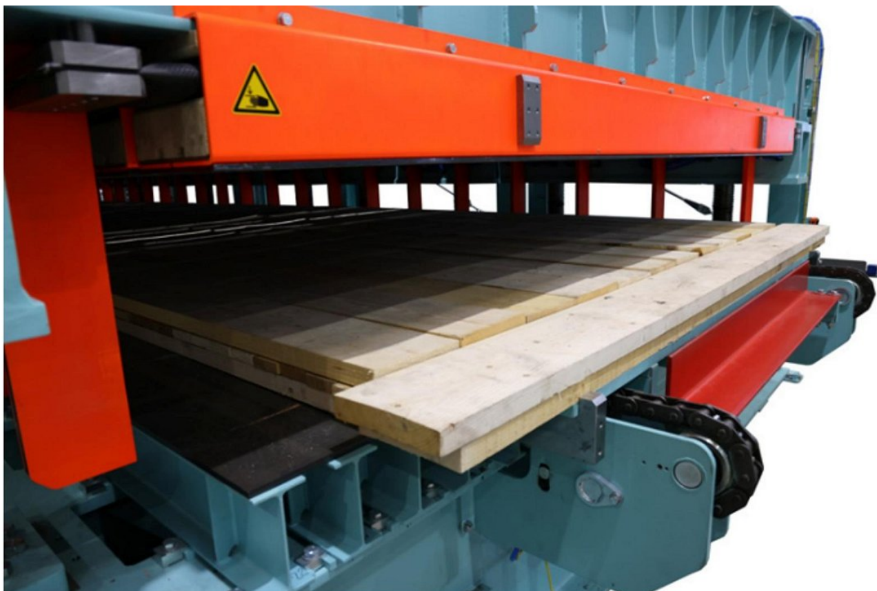
Slika 8: Optimizirana stiskalnica za lepljenje CLT in GLT masivnih lesnih elementov
