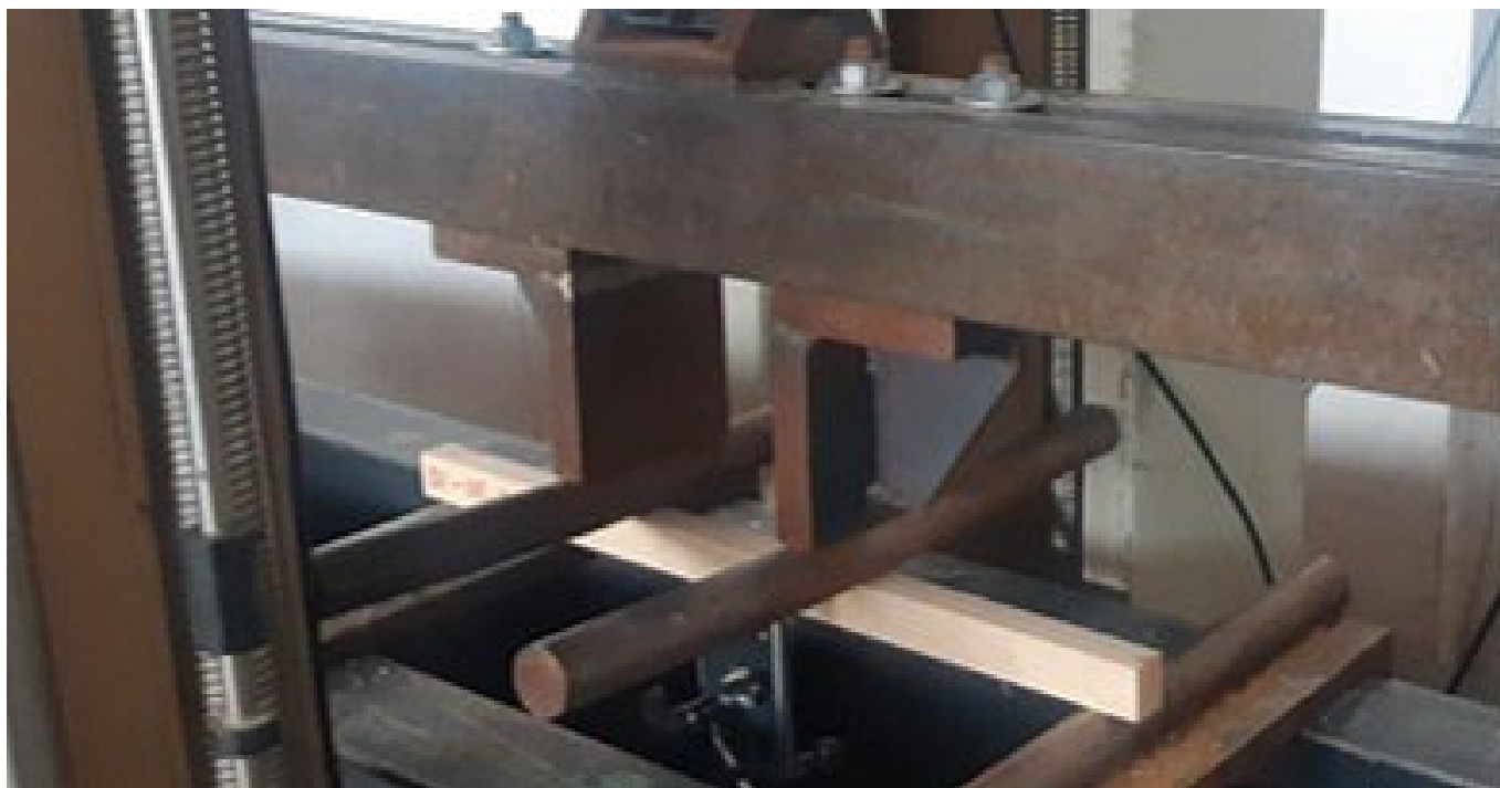
Slika 12: Upogibni preizkus na manjših preizkušancih.
