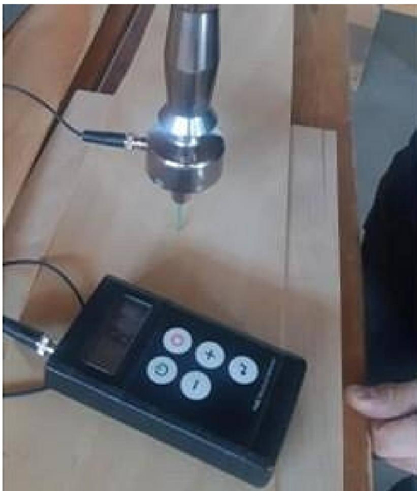
Slika 6: Meritev vlažnosti furnirja z vlagomerom.
