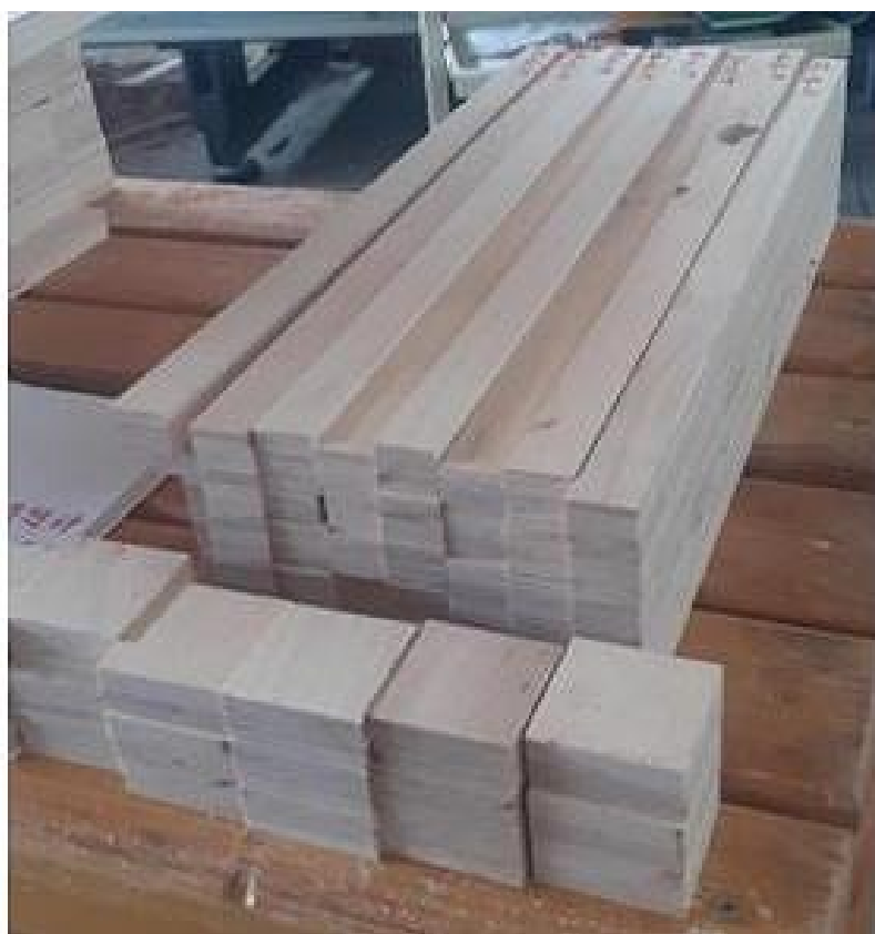
Slika 10: Vzorci manjših preizkušancev za upogibne preizkuse (zgornji) in vzorcev manjših dimenzij za natezne preizkuse (spodaj).
