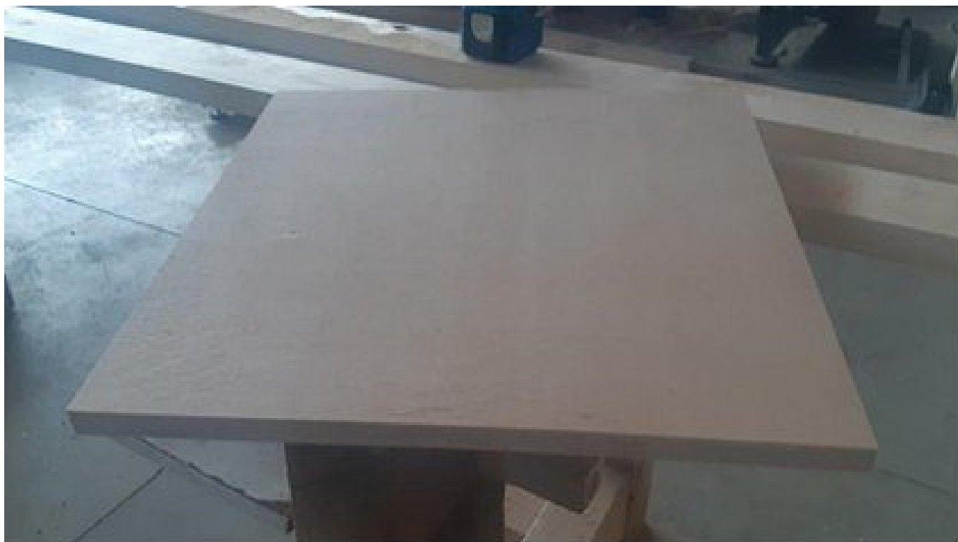
Slika 9: Plošča iz slojnatega furnirnega lesa dimenzij 500 x 500 mm, uporabljena za izdelavo vzorcev manjših dimenzij.
