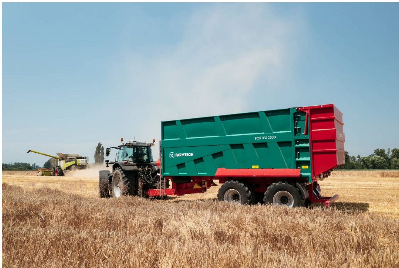
Slika 1: Nova generacija Farmtechovih prikolic s potisno steno Fortex je na voljo s tandem (2 modela) ali tridem podvozjem (en model).
