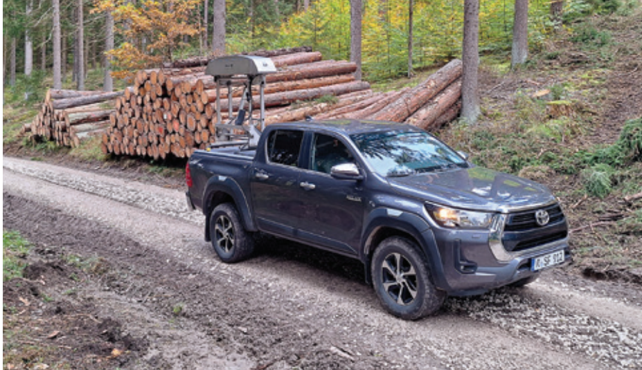
Merilna kamera, integrirana na terensko vozilo
