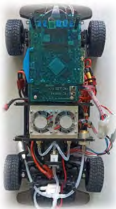
SLIKA 1: Modelni avtomobil na gorivne celice
