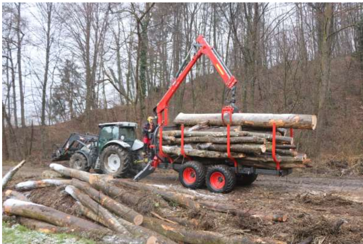
Slika 3: Vlačenje lesa po tleh ni več edina možna raba gozdnih vlak. Obstajajo tudi druge oblike spravila lesa in upravičene rabe vlak, ki ne potrebujejo nujno prečnih naklonov pobočnih vlak navznoter. (Foto: M. Dolenšek)
