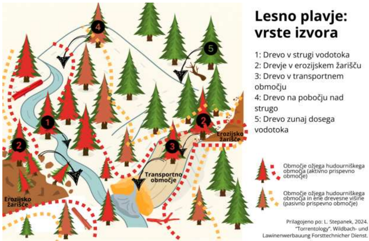
Slika 2: Shematski prikaz vrst izvora lesnega plavja v aktivnem in pasivnem prispevnem območju
