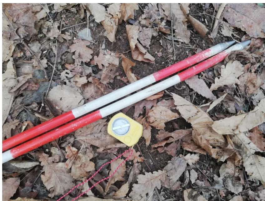
Slika 10: Z merjenjem naklona z libelo in metrom lahko nadomestimo meritve s padomerom in trasirko. Primer na sliki prikazuje vzdolžni naklon vlake 56 cm / 200 cm = 28 %. (Foto: G. Ogrin)
