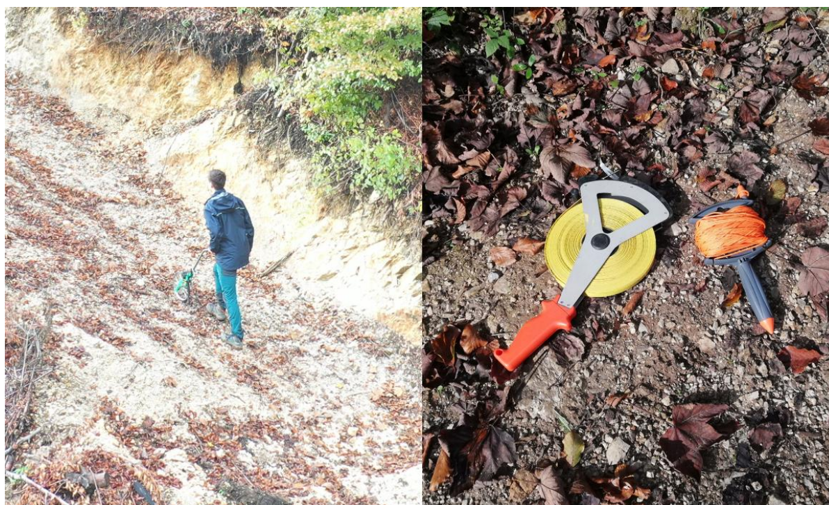
Slika 9: za meritve dolžine lahko profesionalno merilno kolo (levo) nadomestimo z vrvico in daljšim tračnim metrom (desno) (Foto: J. Saražin)
