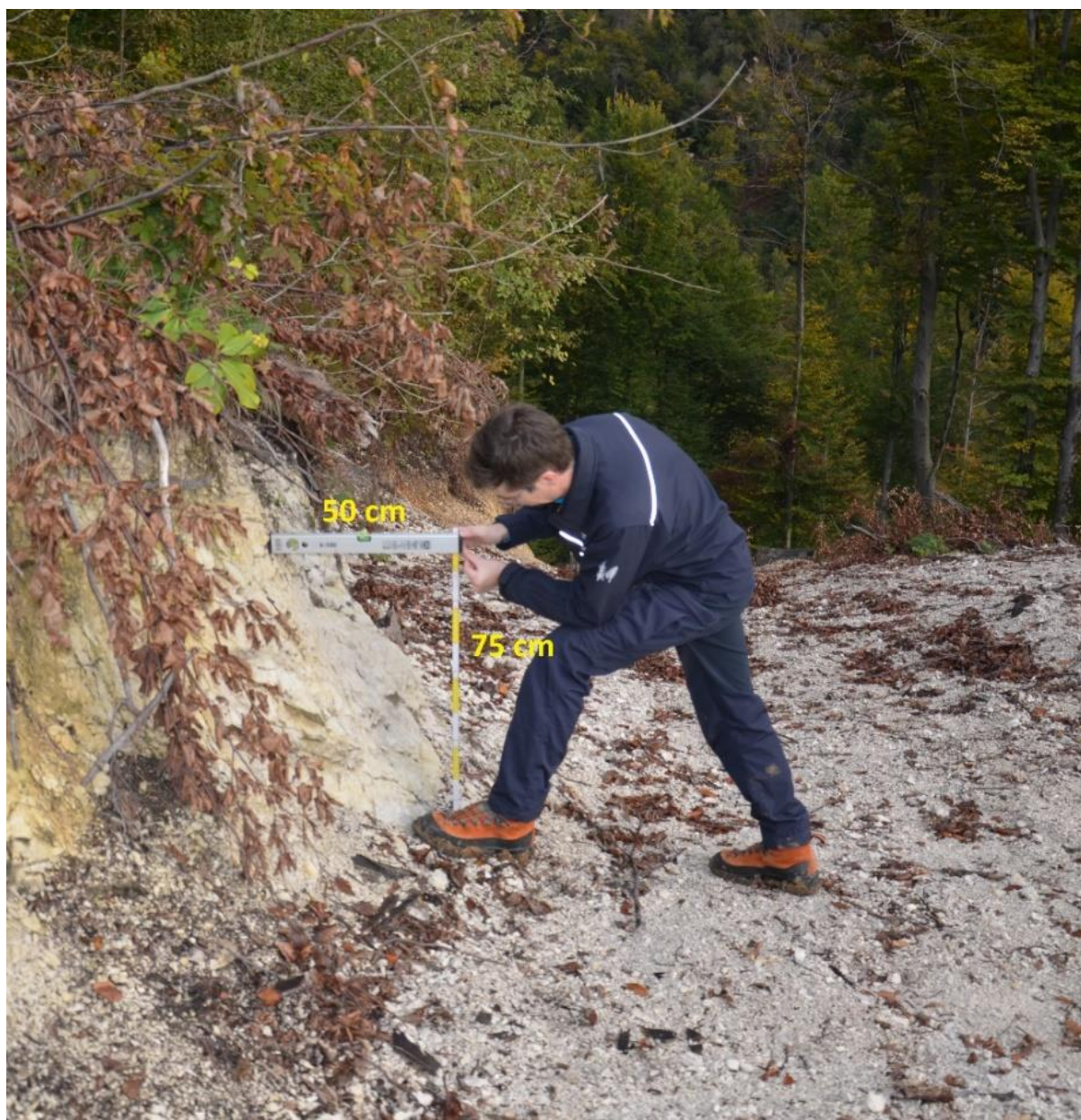
Slika 11: Primer merjenja naklona odkopne brežine z libelo in metrom. Na sliki je prikazan naklon odkopne brežine 75 cm / 50 cm = 150 %, oz. običajno v elaboratu vlake zapisano kot 3:2
