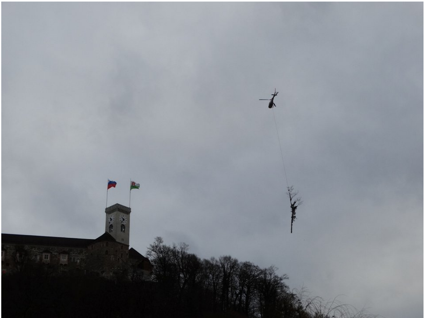
Slika 3: Enomotorni helikopter Airbus H125 v upravljanju podjetja WUCHER Helicopter GmbH lahko prevaža tovore do mase 1050 kg (Foto: J. Saražin)
