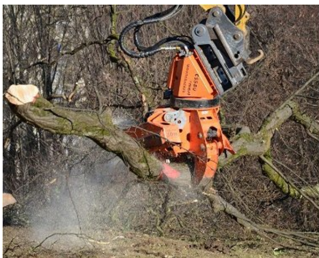
Slika 5: Z manjšimi kosi se bolje izkoristi uporabna prostornina kontejnerja (Foto: M. Dremelj)
