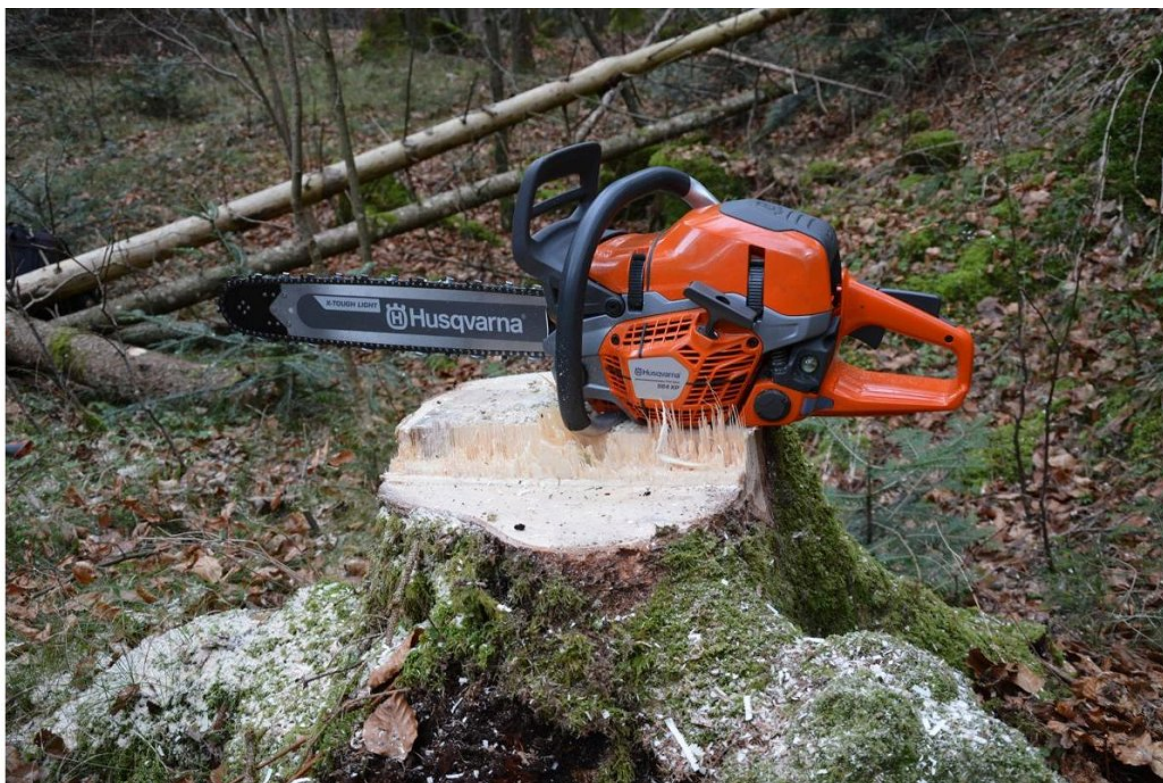
Slika 1: Nova Husqvarna žaga z bencinskim motorjem 564 XP z močjo motorja 4,0 kW in maso 5,8 kg.
