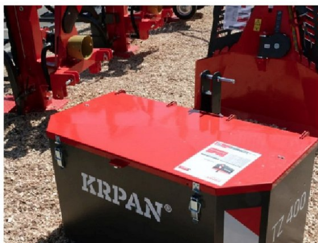
Traktorski zaboj Krpan je, po avtorjevem poznavanju, prvi tovrstni zaboj za orodje za namestitev na sprednje ali zadnje tritočkovno hidravlično dvigalo.
