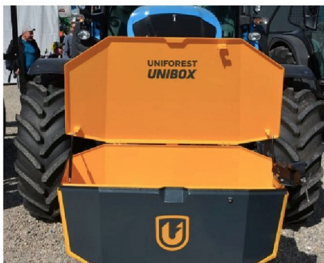
Uniforest oglašuje, da se njihov UNIBOX zaboj za orodje lahko uporablja tudi kot sprednja utež. Navajajo nosilnost 500 kg.
