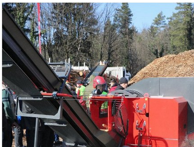
Rezalno cepilni stroj CSKZ 4218 PRO s krožno žago (žagalnim listom), elektrohidravličnim krmiljenjem in vlečene izvedbe. Na prikazu z verižno rampo za hlodovino.
