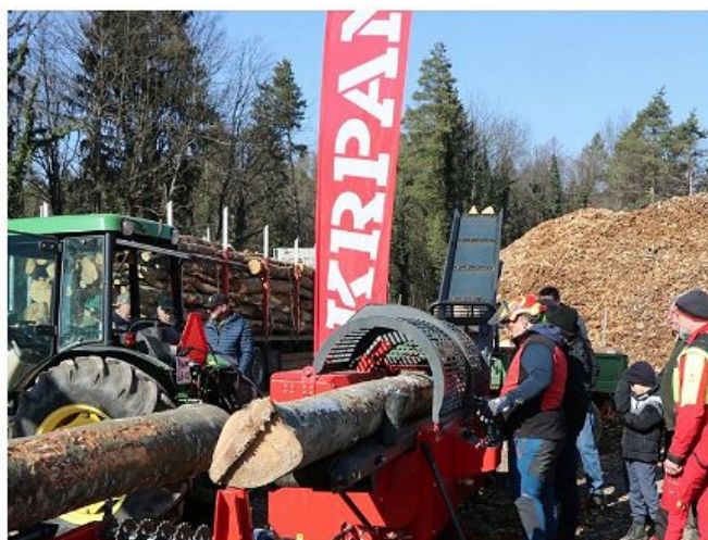
Rezalno cepilni stroj CS 4218 PRO z verižno žago, elektrohidravličnim krmiljenjem in nošene izvedbe. Na prikazu z dvizno mizo za hlodovino.
