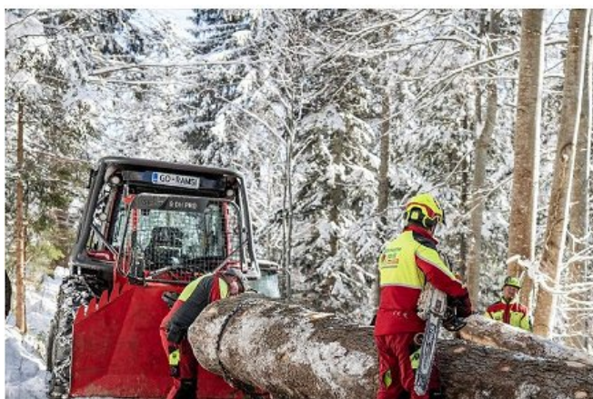
Pri Vitlih Krpan so gozdarski vitli njihov tradicionalni in še vedno vodilni izdelki. Na zimski demo turneji so prikazali najnovejše vitle z verižnim pogonom EH/EHP in zobniškim pogonom ter konstantno vlečno silo DH PRO (na sliki).
