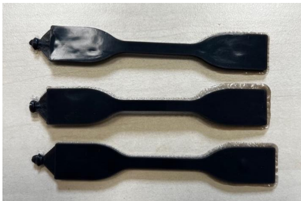
Slika 21: Primer nabrizganih epruvet
