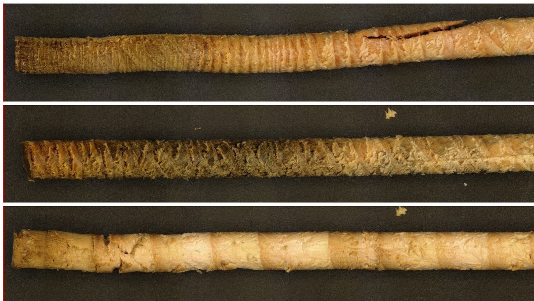
Slika 5: Primeri izvrtkov, odvzeti iz analiziranih drogov (drog 57-A zgoraj, drog 68, sredina in drog 58 spodaj)
