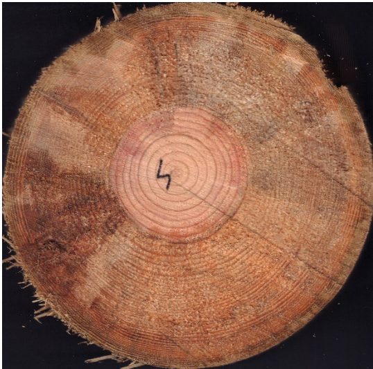
Slika 6: Presek predčasno propadlega drogu – Podjetje A. Kolut je odvzet 2 m pod vrhom droga.
