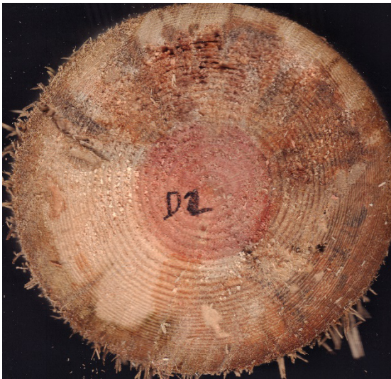
Slika 7: Preseki predčasno propadlega drogu – proizvajalec B. Kolut je bil izoliran sredi droga.
