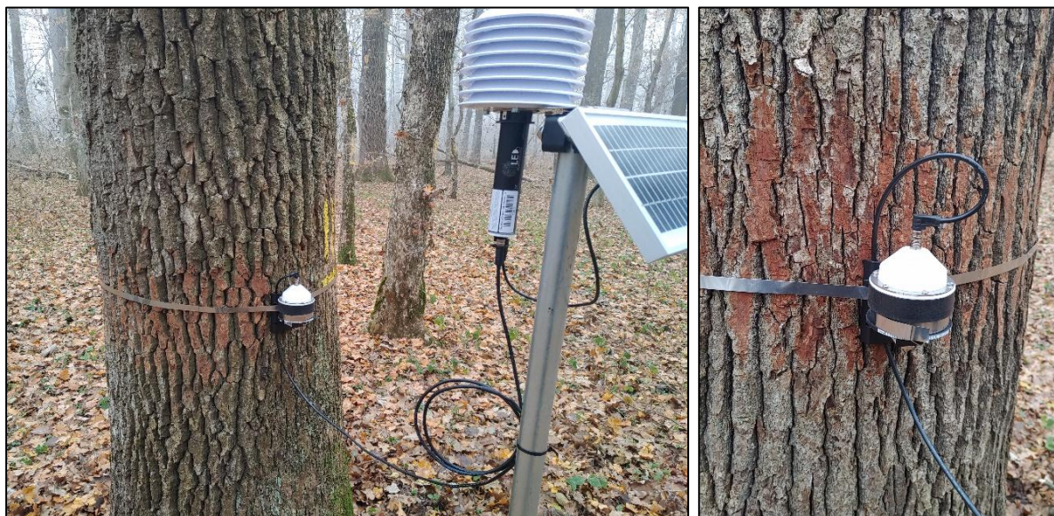
Slika 51: Tipična instalacija enega merilnega mesta z elektronskim dendrometrom, zbiralnikom podatkov in različnimi okoljskimi senzorji. Senzorji za vsebnost vode v tleh in temperaturo tal na 30 cm niso vidni, ker so zakopani v tla.
