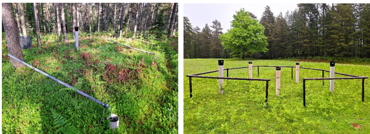
Slika 82: Prikaz vzorčevalnikov za usedline na ploskvah intenzivnega spremljanja gozdnih ekosistemov znotraj sestoja (levo) in na odprtem (desno) (Foto: M. Rupel)
