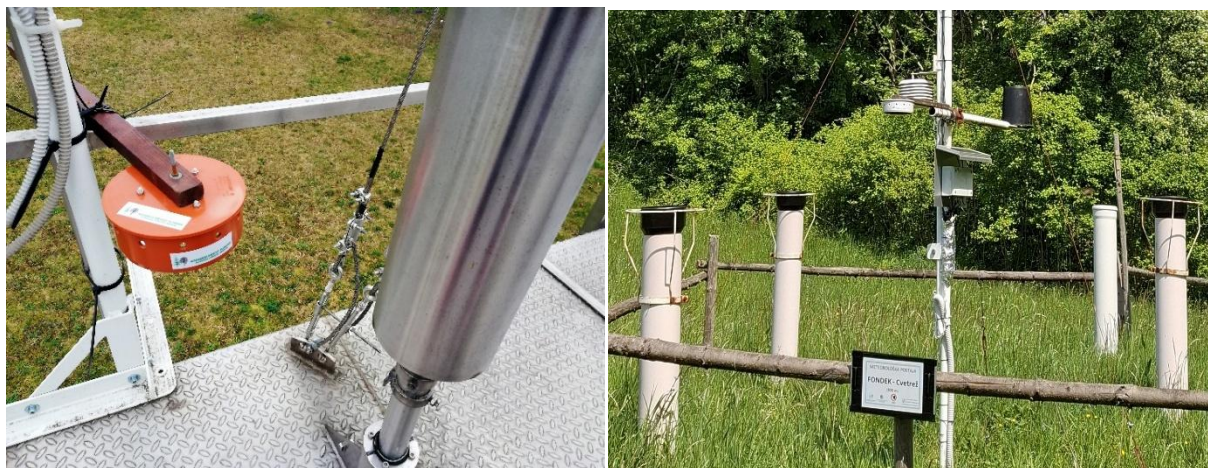
Slika 92: Kontrolne meritve ozona z difuzivnimi vzorčevalniki na merilni postaji ARSO v Ljubljani (april 2022) – levo ter meritve ozona z difuzivnimi – pasivnimi vzorčevalniki na meteorološki postaji na IMG E ploskvi Fondek – desno (Foto: M. Rupel)
