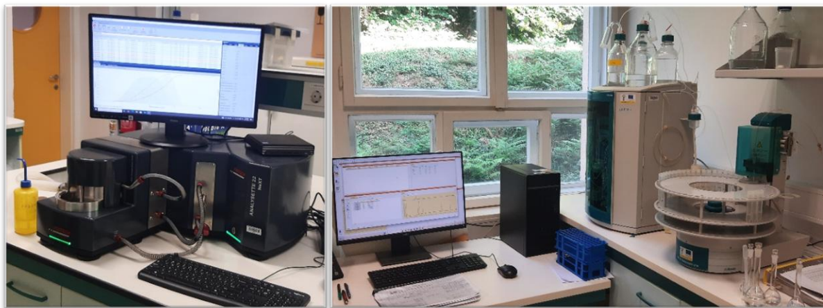
Slika 130: Laserski difraktometer za določanje teksture talnih vzorcev (levo) in ionski kromatograf za določanje kationov v vodnih vzorcih (desno) (Foto: D. Žlindra)
