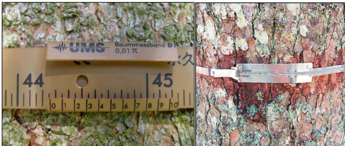
Slika 43: Spremembe v premeru debla odčitavamo na desetinko milimetra natančno, kar omogoča nonijska skala. Na sliki levo je ročni dendrometer nemškega proizvajalca UMS München, ki kaže absolutne spremembe premera, na sliki desno pa ročni dendrometer češkega proizvajalca EMS Brno, ki kaže spremembo obsega, premer pa moramo izmeriti posebej.
