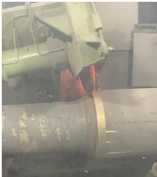
Slika 1: primer brušenja z vroče stiskano brusno ploščo
