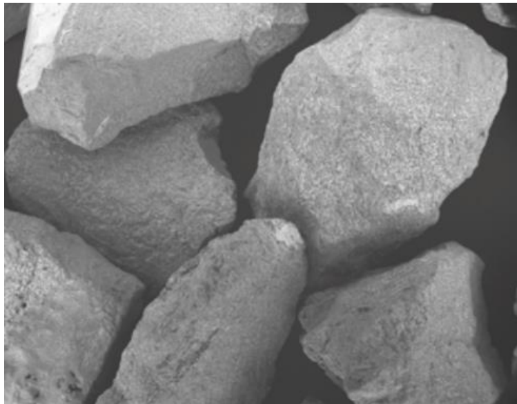
Slika 17: Makrostruktura cirkonijevega korunda [6]
