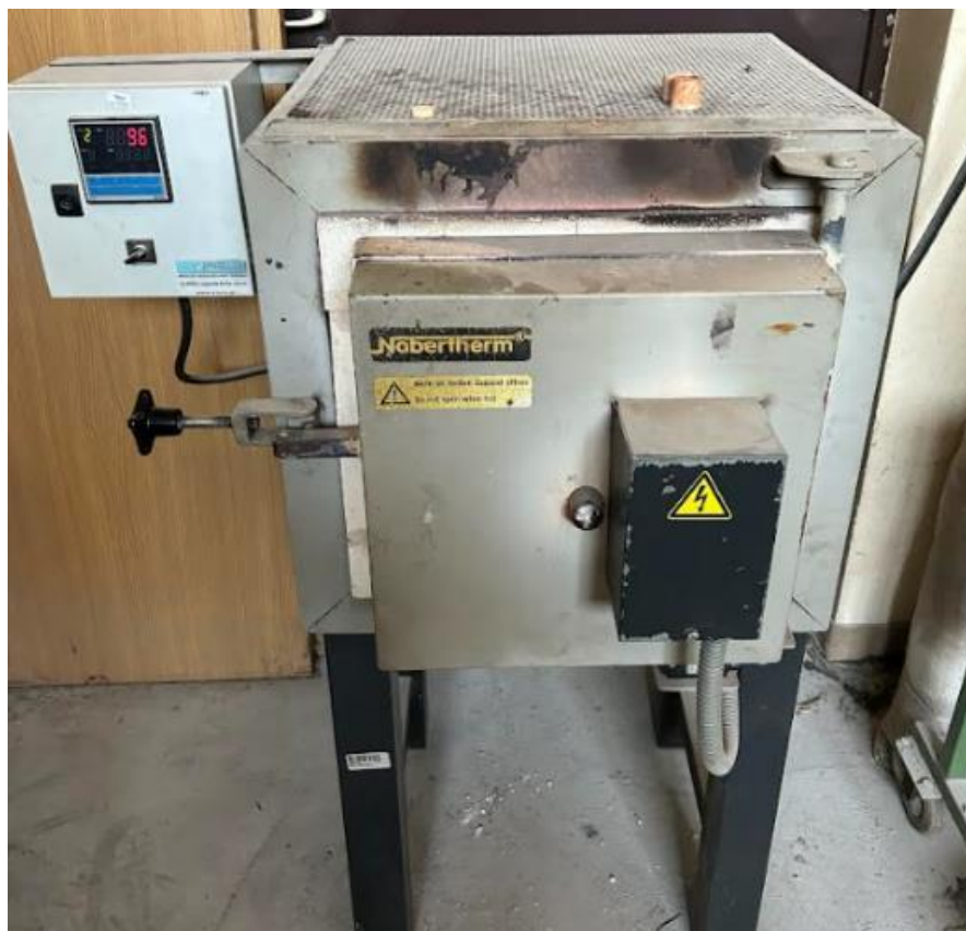
Slika 23: Peč za temperaturno popuščanje etalonov (zunanost)
