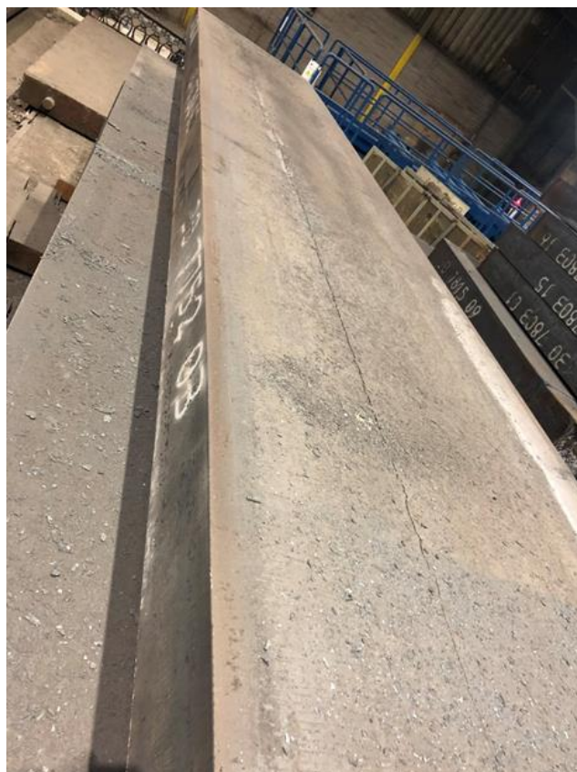
Slika 9: Vzdolžna razpoka na nebrušenem slabu [4]
