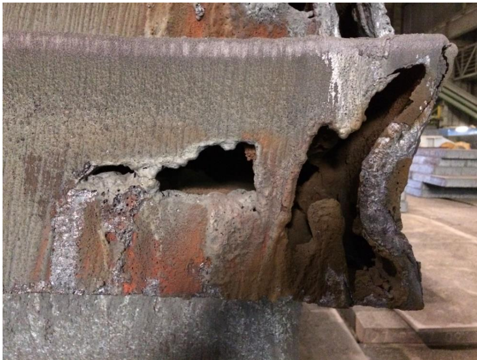
Slika 11: Vzdolžno prerezan slab z lunkerjem [4]
