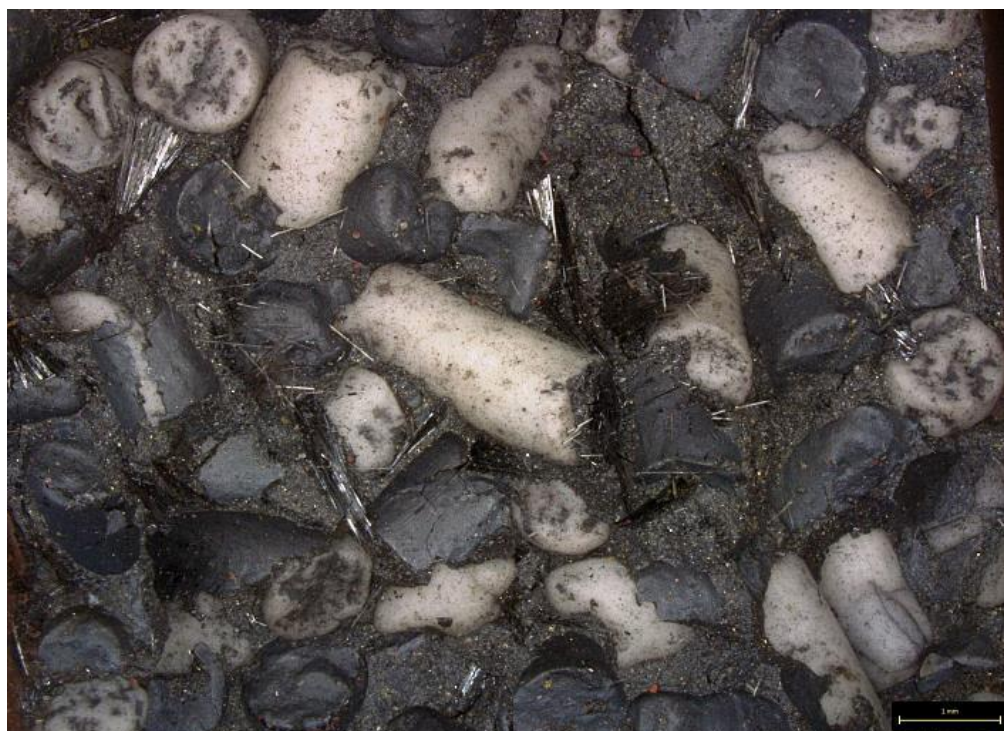
Slika 25: Mikroskopski prikaz brusne plasti (brez zaviralca gorenja) po 40 minutnem popuščanju
