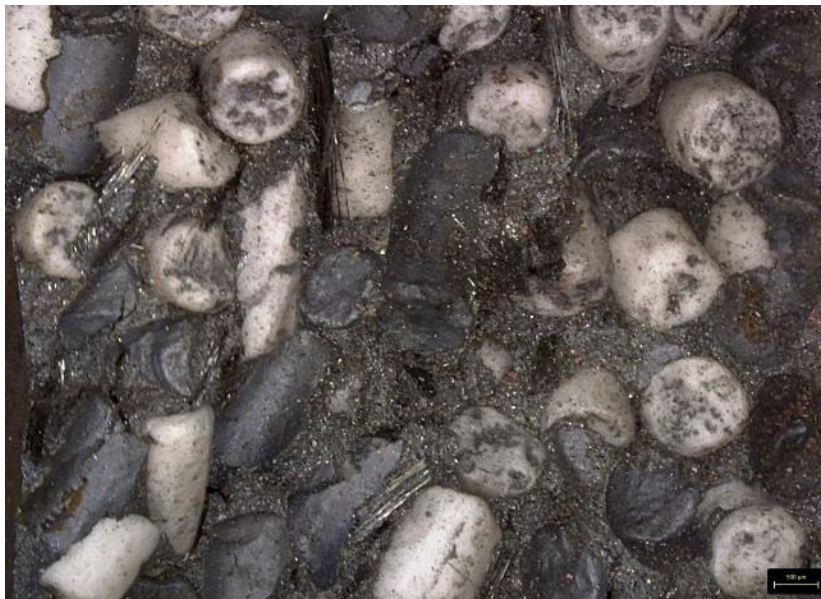
Slika 27: Mikroskopski prikaz brusne plasti (z zaviralcem gorenja) po 40 minutnem popuščanju
