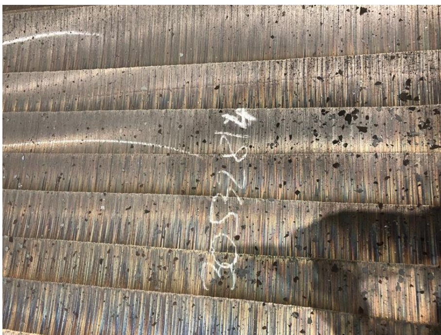
Slika 10: Vzdolžna razpoka na brušenem slabu [4]
