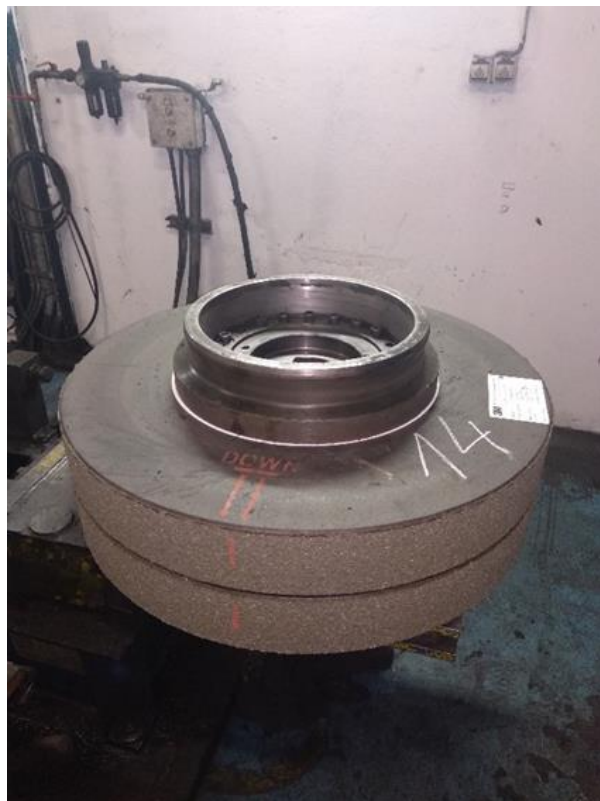
Slika 2: Pravilno sestavljen par brusnih plošč
