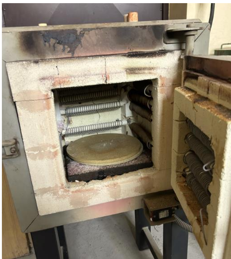
Slika 22: Peč za temperaturno popuščanje etalonov (notranjost)
