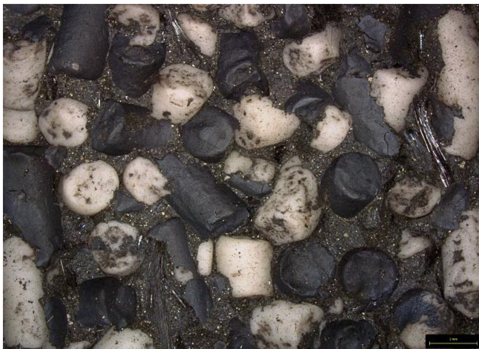
Slika 24: Mikroskopski prikaz brusne plasti (brez zaviralca gorenja) po 20 minutnem popuščanju
