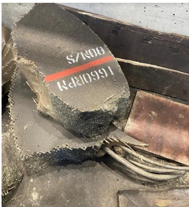
Slika 4: primer razletene brusne plošč
