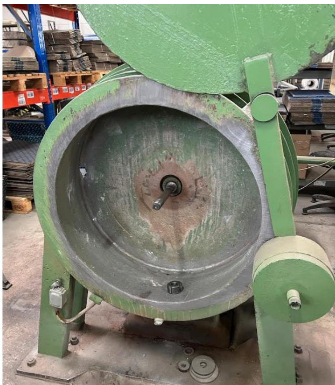
Slika 30: Stroj za preizkus brusne plošče na povečano obodno hitrost
