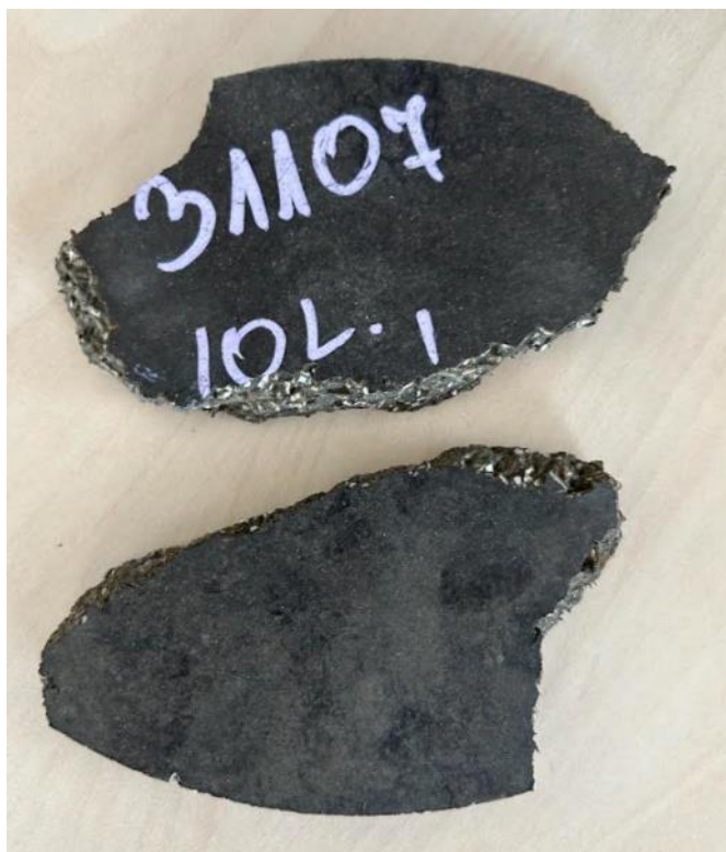
Slika 28: Razlet etalona z dodatkom zaviralca gorenja
