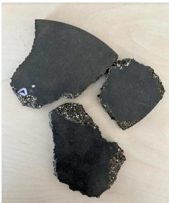
Slika 29: Razlet etalona brez zaviralca gorenja
