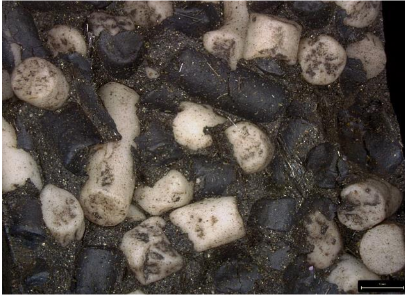
Slika 26: Mikroskopski prikaz brusne plasti (z zaviralcem gorenja) po 20 minutnem popuščanju
