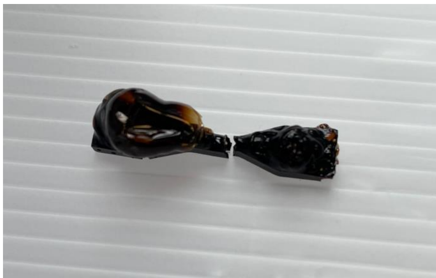
Slika 20: Zamrežen vzorec lignin-epoksidne smole
