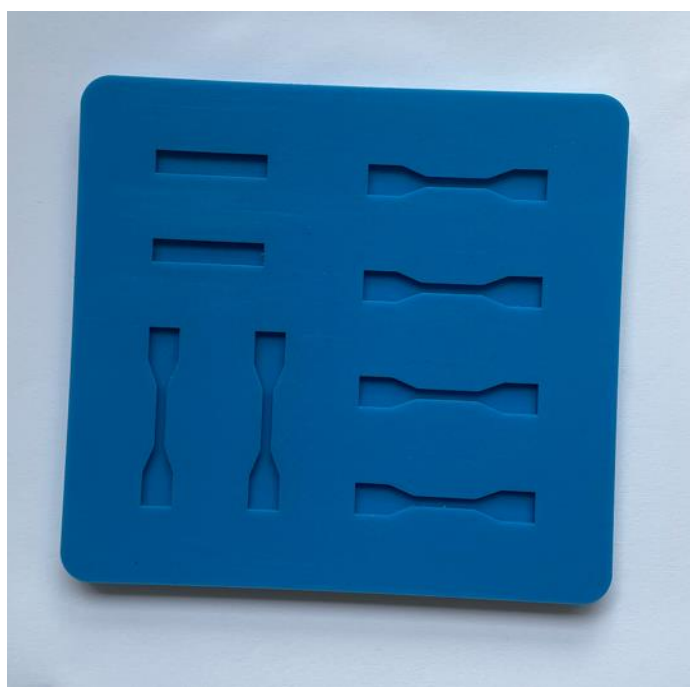
Slika 18: Silikonski kalup za pripravo epruvet, skladnih s standardom ISO 527-2-1BB
