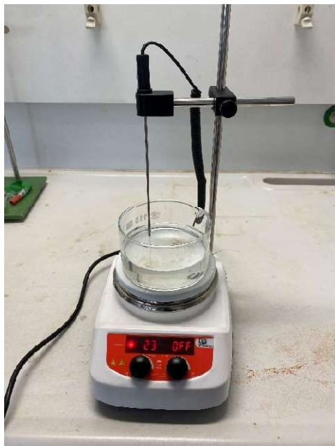
Slika 4: Oljna kopel, grelec ter stojalo s tipalom
