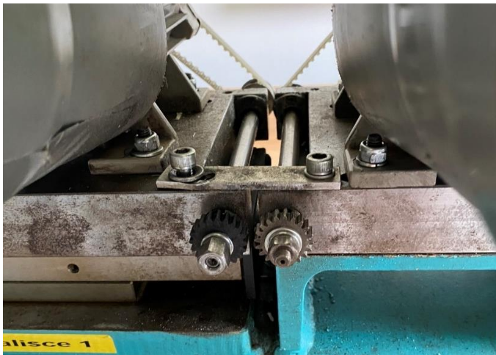
Slika 16: 3D-natisnjen zobnik PA6-CF s 42CrMo4+QT
