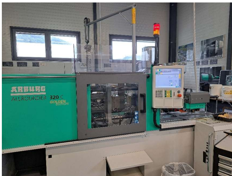
Slika 4: Brizgalni stroj znamke ARBURG, ALLROUNDER 320 C GOLDEN EDITION
