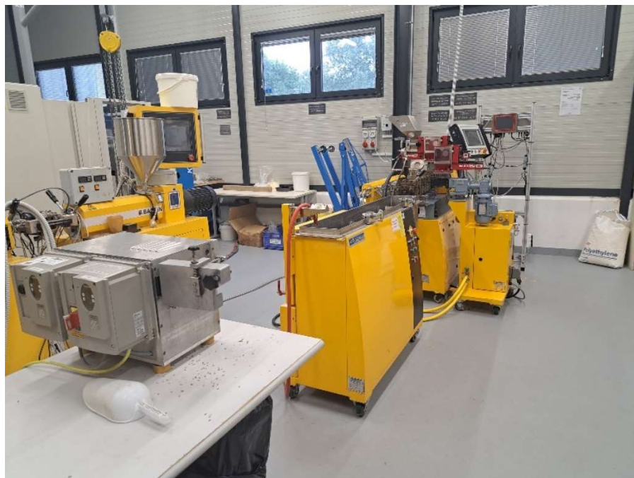
Slika 3: Dvopolžni ekstruder z vodno kopeljo in dozirniki ter granulator filameta
