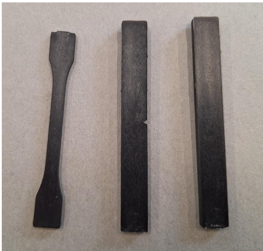
Slika 7: Vzorci po ISO 527 (levo), ISO 178 (desno) in ISO 179 (sredina)
