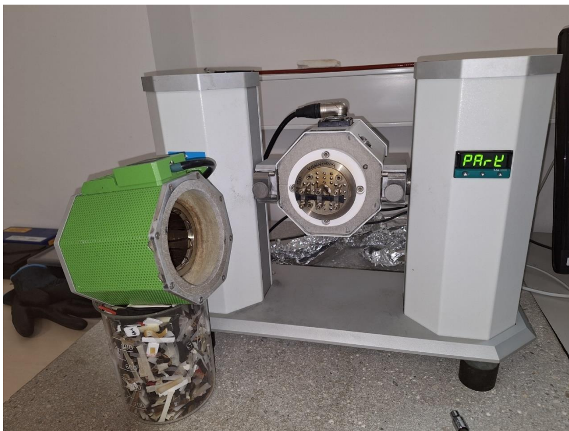
Slika 11: Vzorec, vpet v analizator DMA 8000
