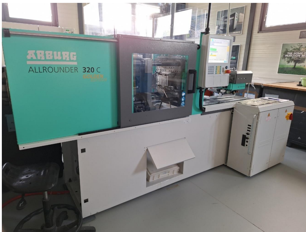
Slika 5: Stroj za brizganje Arburg Allrounder 320 C 500 – 100
