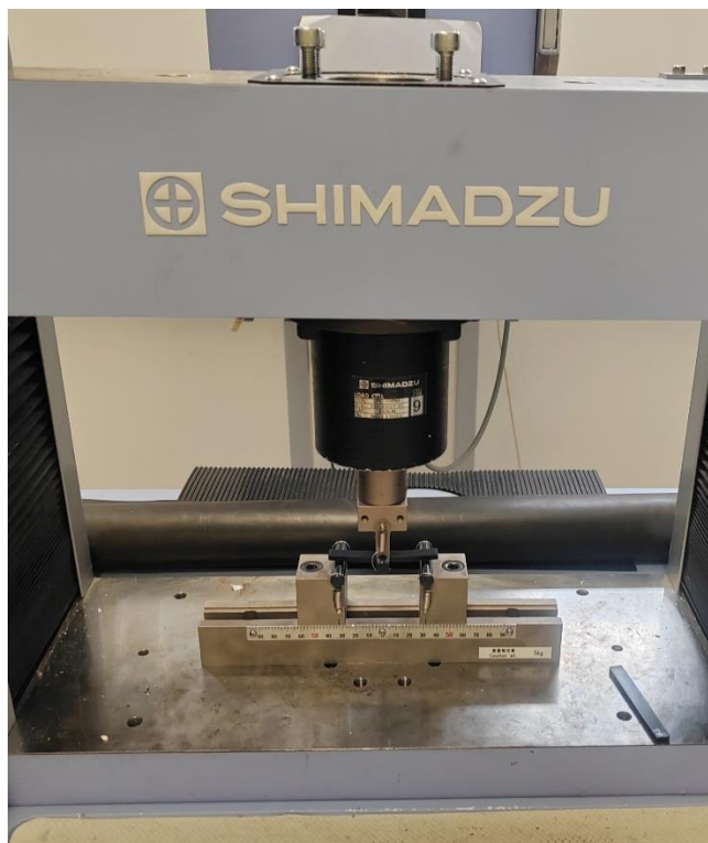
Slika 13: Vzorec, nameščen pri upogibnem testu na napravi Shimadzu
