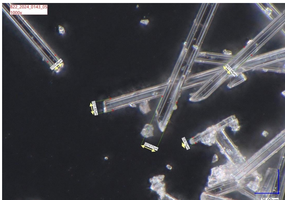
Slika 69: Premer vlaken pri povečavi 1000x za vzorec 5
