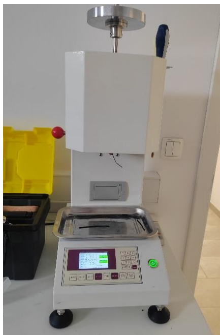
Slika 18: Naprava LILI MFI LY-RP za merjenje indeksa tečenja taline
