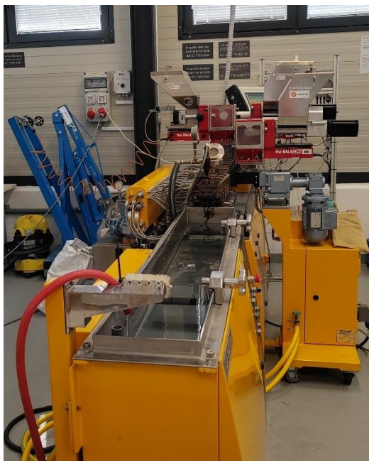
Slika 9: Dvopolžni ekstruder z vodno kopeljo
