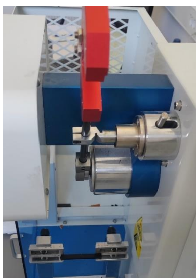
Slika 15: Charpyjev preizkus z zarezo
