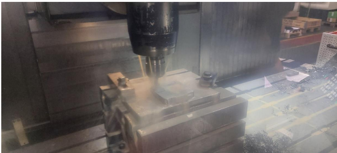
Slika 27: Fina obdelava izmetalnega vložka
