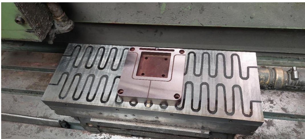
Slika 26: Brušenje delilne ravnine vložkov
