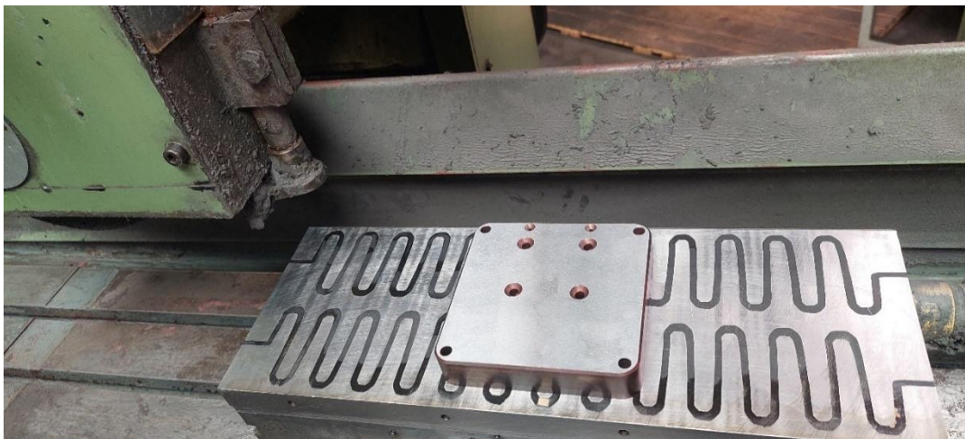
Slika 25: Brušenje spodnje strani vložkov
