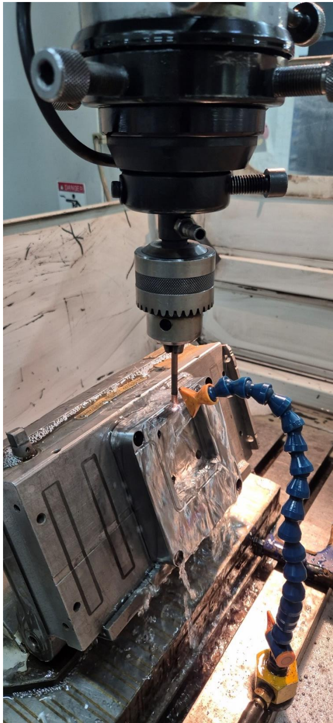
Slika 32: Izdelava dolivka na izmetalnem vložku
