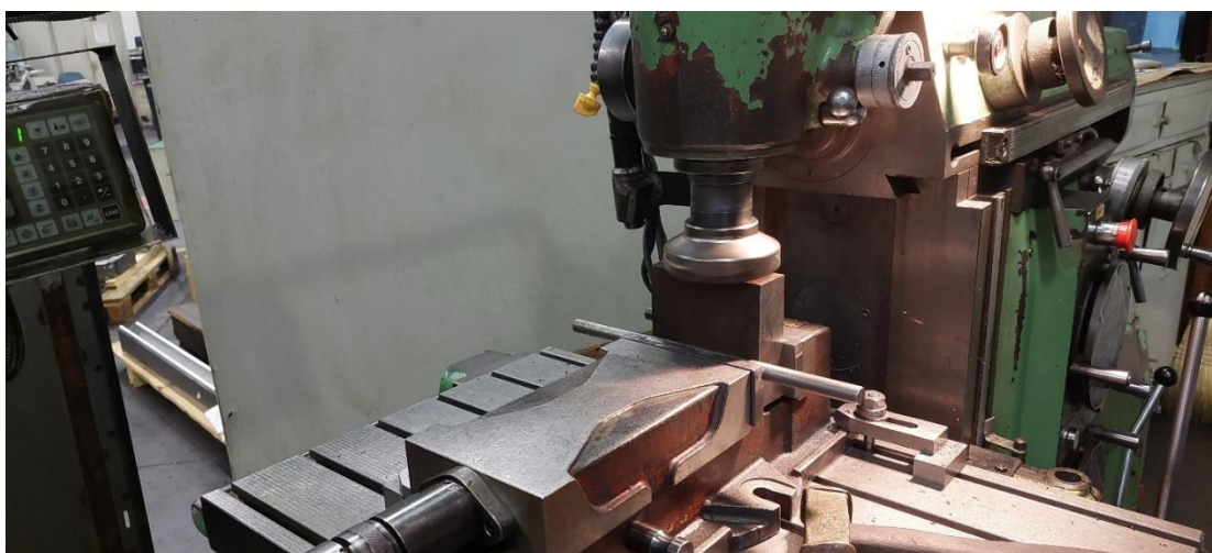
Slika 19: Grobo rezkanje debeline ter pravokotnosti vložkov
