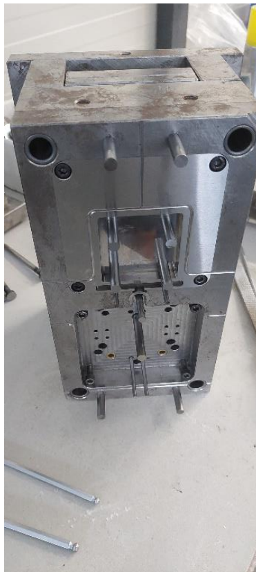
Slika 33: Montiran izmetalni del orodja
