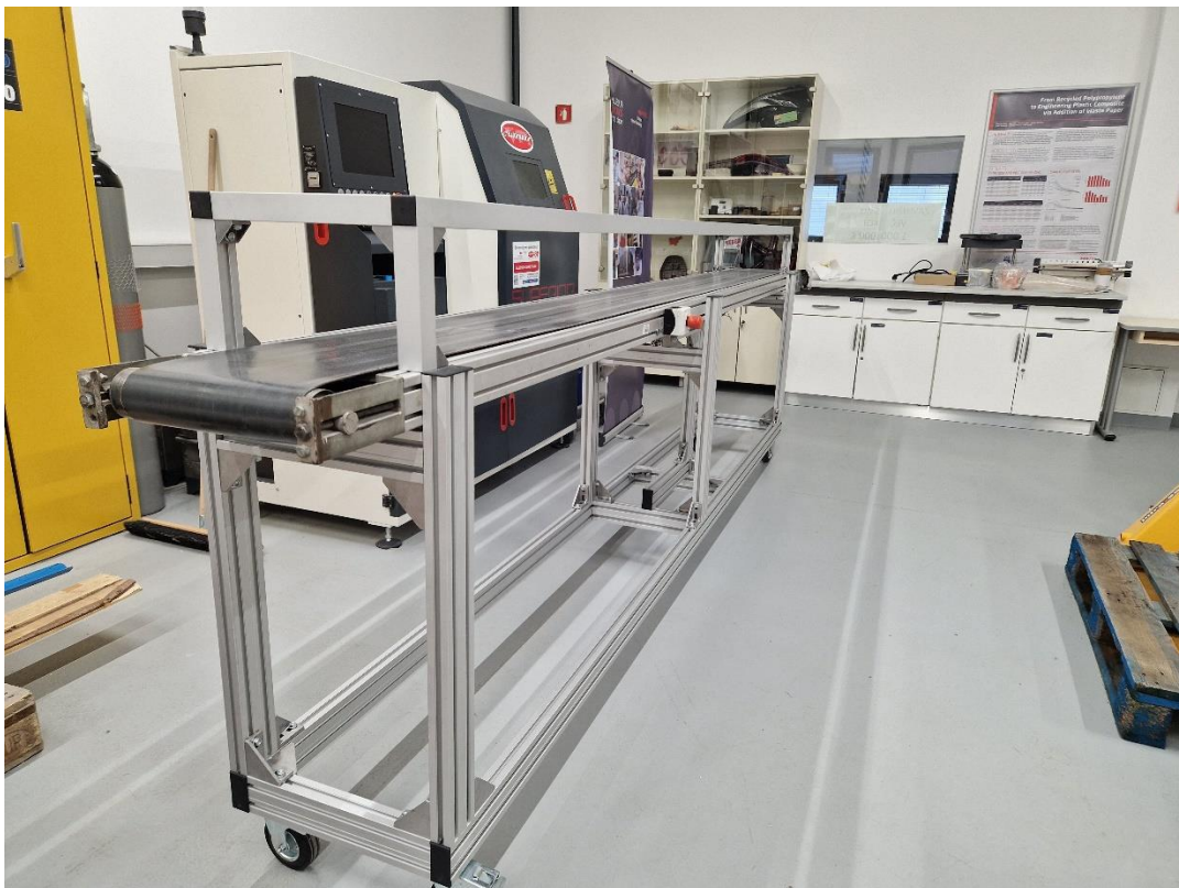
Slika 44: Dejanska izvedba tekočega traku za ekstruzijo filamenta z zračnim hlajenjem
