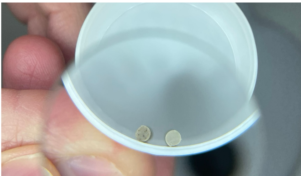
Slika 18: Presek 2-minutnega polidomenskega PDTKE vzorca (levo) in 3-minutnega polidomenskega vzorca (desno)
