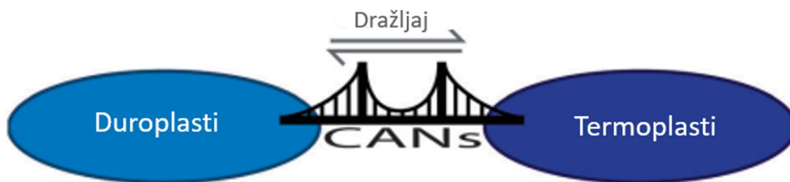
Slika 1: CAN-i kot povezava med termoplasti in duroplasti [4]
