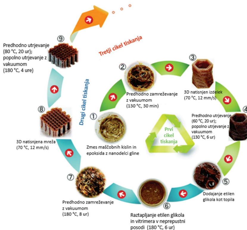
Slika 8: Recikliranje vitrimerov s 3D tiskanjem [11]
