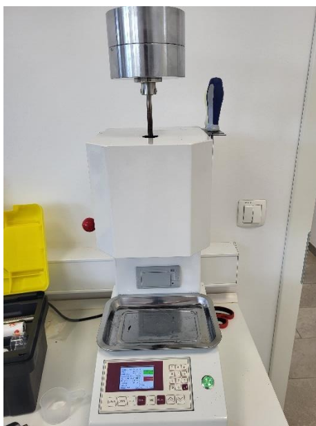
Slika 17: Naprava za MFI – indeks tečenja taline
