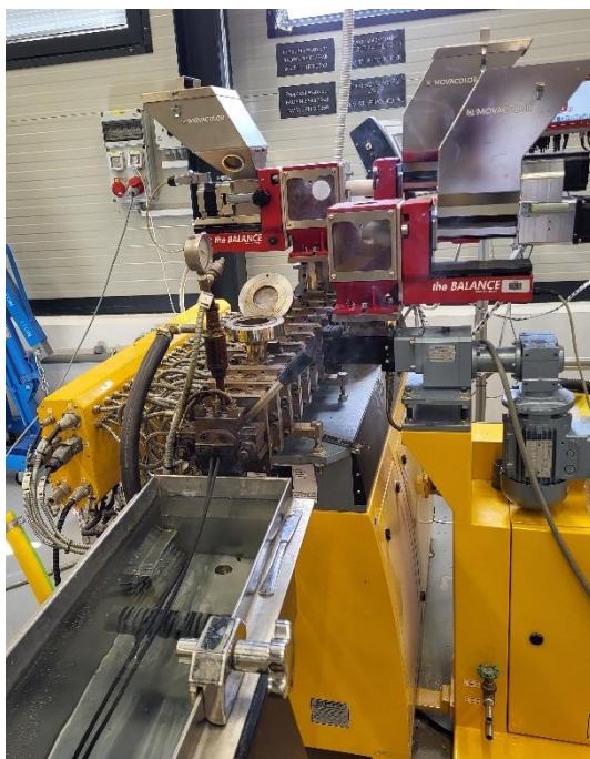
Slika 9: Proces kompavdiranja vzorcev na ekstruderju
