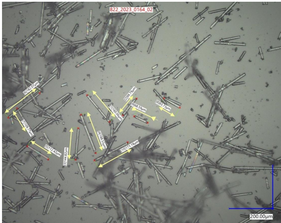
Slika 28: Dolžina steklenih vlaken vzorca 822_2023_0164_02
