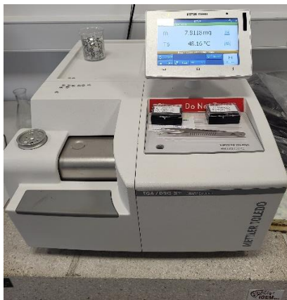
Slika 18: Termogravimetrični analizator TGA (Mettler Toledo)
