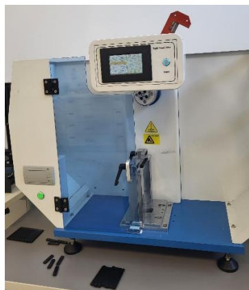
Slika 16: Naprava za merjenje udarne žilavosti (Charpy)
