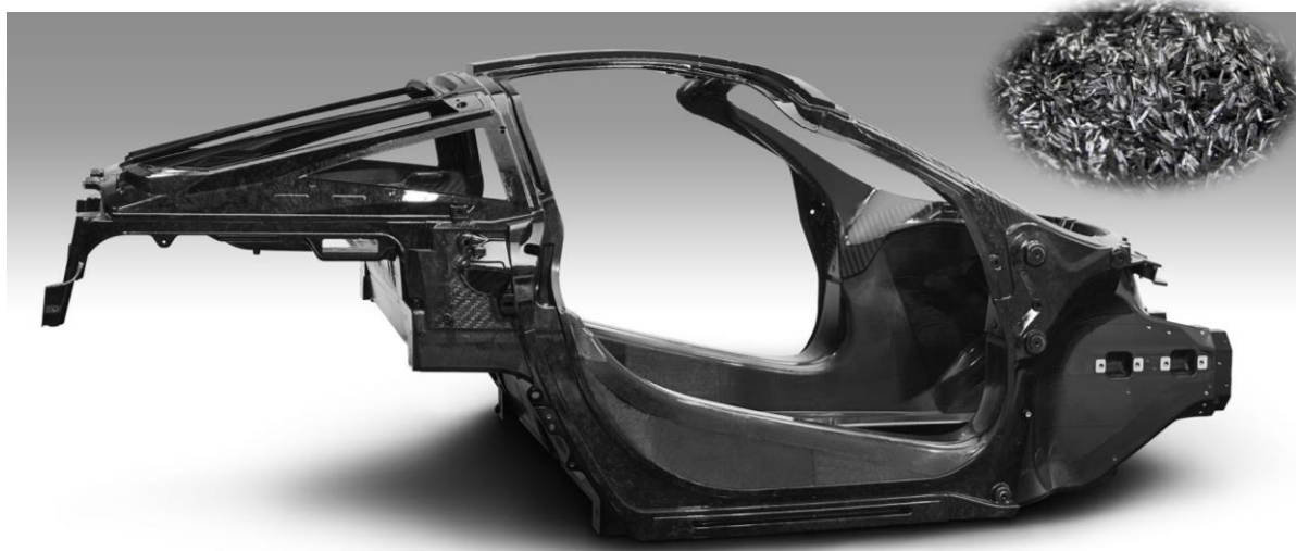
Slika 7: Strukturno ogrodje avtomobila v celoti izdelano iz kompozita z ogljikovimi vlakni [29]
