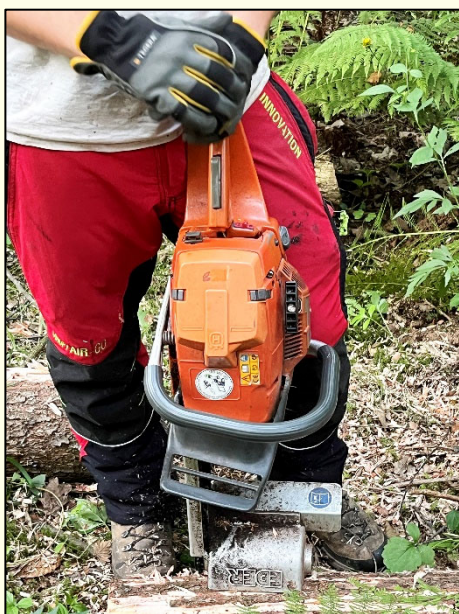
Slika 15: Delavci podjetja Tisa d.o.o. so uporabili napravo za žlebljenje (EDER – Maschinenbau GmbH, Wolfenbüttel, Nemčija) (Foto: M. Jurc)
