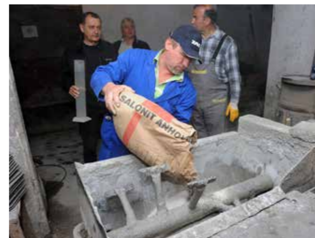
Slika 3: Priprava betonske mešanice v delavnici Izidorja Jesenka (levo) in novi betonski strešniki (desno).
