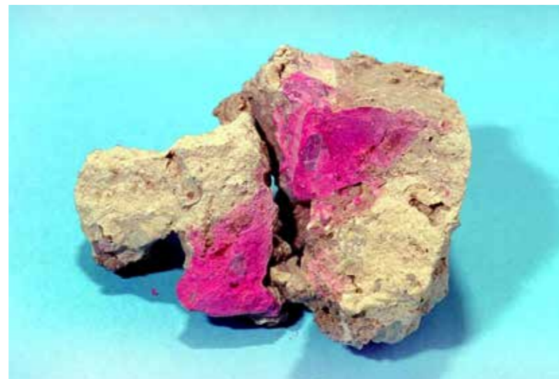
^ Slika 5: Ocena globine karbonatizacije cementnih malt s fenolftaleinom.
