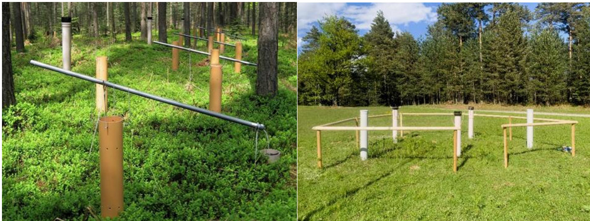
Slika 68: Prikaz vzorčevalnikov za usedline na ploskvah intenzivnega spremljanja gozdnih ekosistemov znotraj sestoja (levo) in na odprtem (desno) (Foto: M. Rupel)
