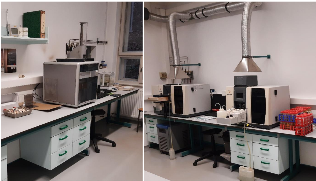
Slika 105: Dva izmed inštrumentov, ki opravita večino analiz, povezanih z vzorci tal. Elementni analizator Elementar Vario Max CNS cube (levo) in atomski absorpcijski spektrometer Varian AA 240 FS in Z (desno).
