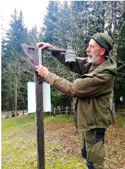
Slika 91: Zamenjava ohišja za dozimetre za pasivno spremljanje ozona ter termometra. Na fotografiji skrbnik Peter Čadež na Pokljuki. (Foto: M. Rupel)
