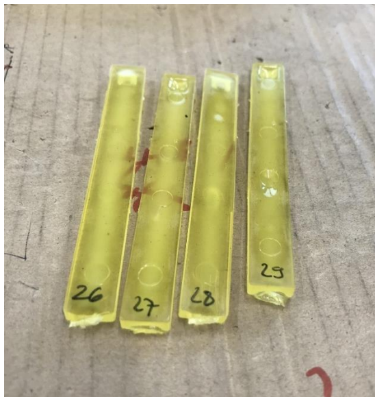
Slika 12: Nezapolnjene epruvete od mešanice PA6 in novolaka v razmerju 70 : 30
