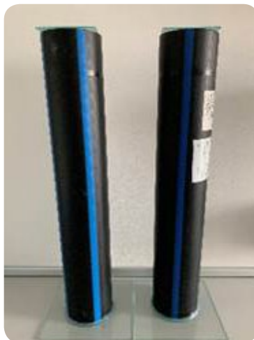
Testiranje cevi za stik s hladno pitno vodo poteka pri sobni temperaturi (23 °C), 72 ur, trikratni zaporedni stik.
