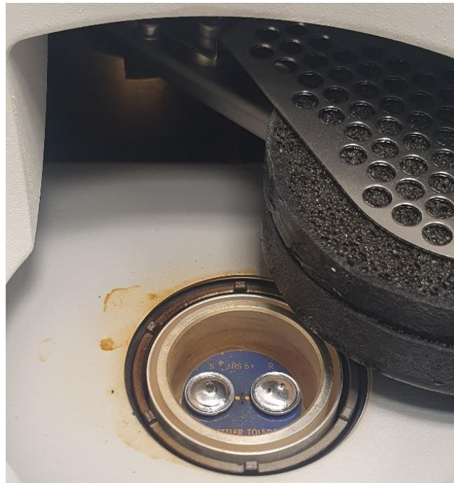
Slika 49: Vzorec, vstavljen za DSC analizo z referenčnim lončkom
