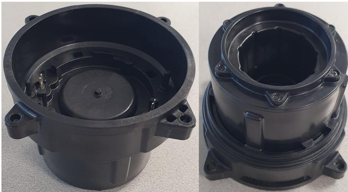
Slika 37: Suha in mokra stran vzorca statorja vodne črpalke, zabrizganega s kompozitom Zytel
