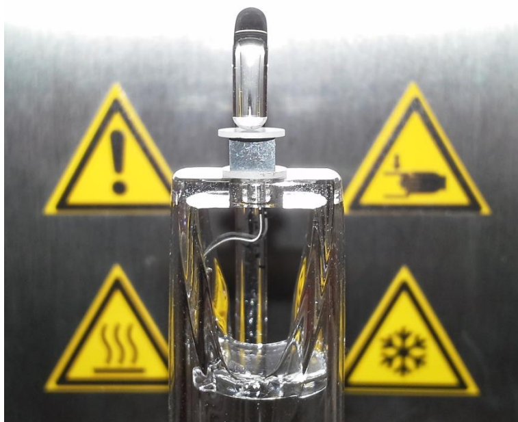
Slika 47: Primer vzorca, vstavljenega v TMA inštrument za analizo
