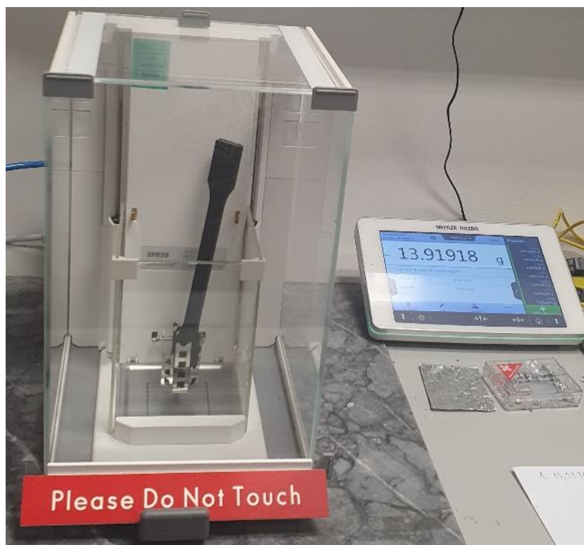
Slika 42: Tehtanje epruvete s posebnim nastavkom na tehtnici Mettler XPR26DR
