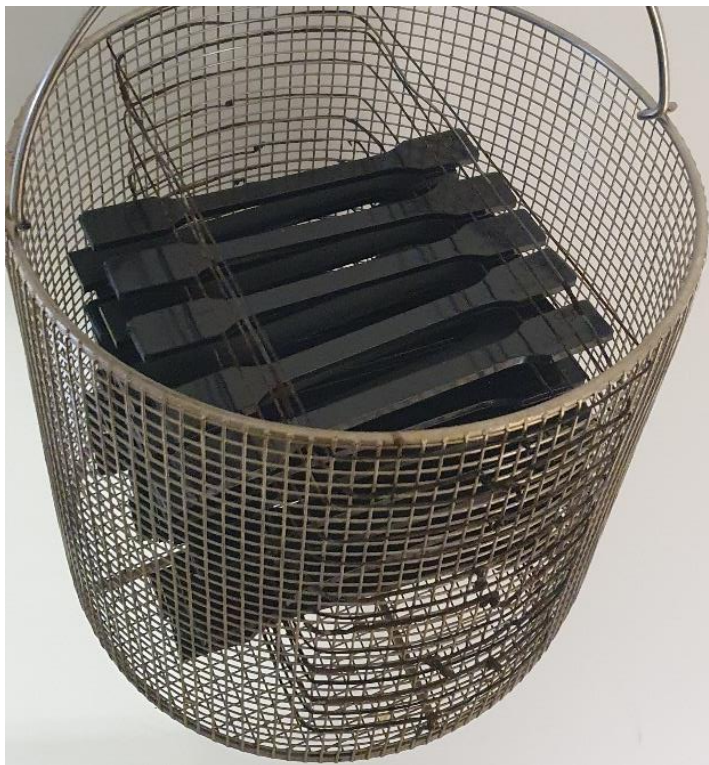
Slika 41: Vzorci epruvet v kletki avtoklava
