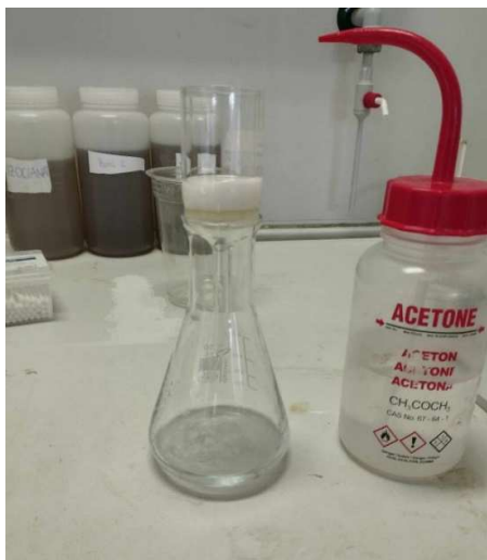
Slika 27: Filtriranje produkta skozi keramični filter
