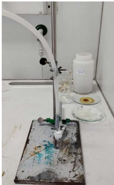
Slika 24: Prepihovanje zatehtane mešanice v steklenički z inertnim plinom dušikom
