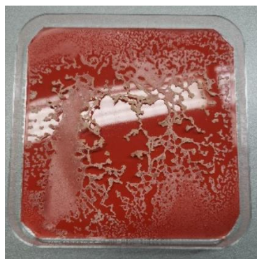
Slika 6: Biokompozit na osnovi agarja s 6 % CNC
