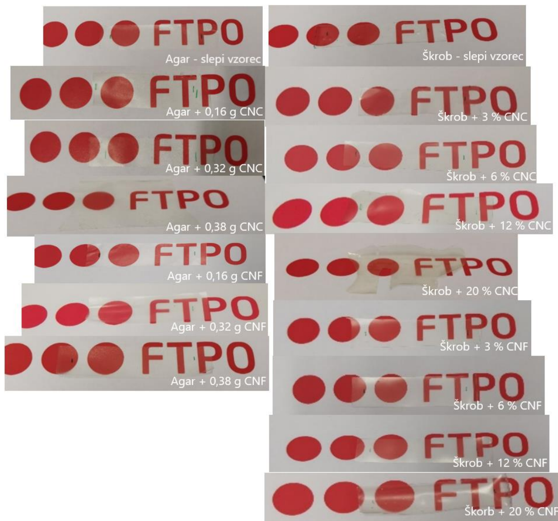
Slika 10: Primerjava transparentnosti vseh biokompozitov
