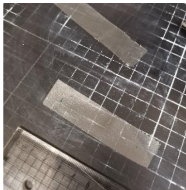
Slika 9: Priprava filmov za natezni preizkus
