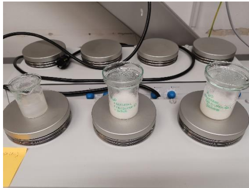
Slika 8: Segrevanje pripravljenih raztopin biokompozitov na osnovi škroba
