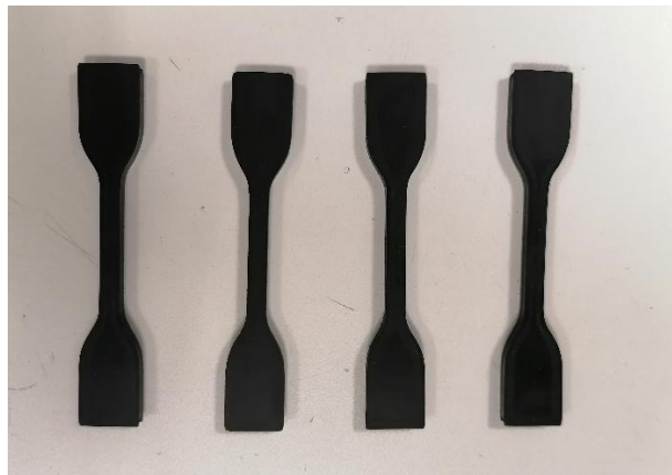
Slika 7: Vzorci za natezni preizkus po ISO 37
