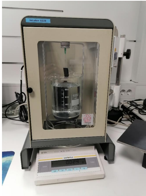
Slika 11: Tehnica za merjenje gostote
