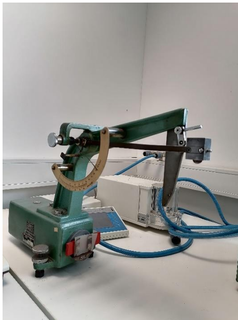
Slika 17: Naprava za merjenje odbojne odpornosti
