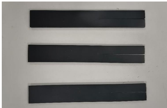
Slika 8: Vzorci za natezni preizkus po ISO 34-1 A
