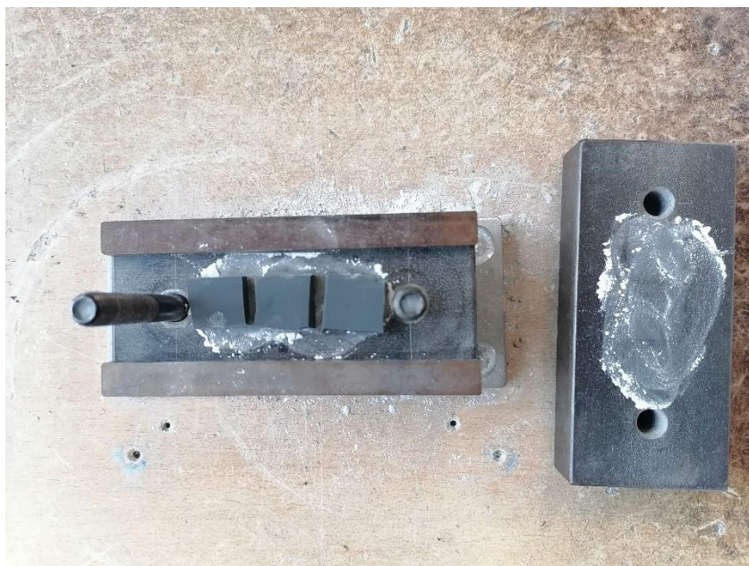
Slika 14: Priprava vzorcev za merjenje tlačne deformacije
