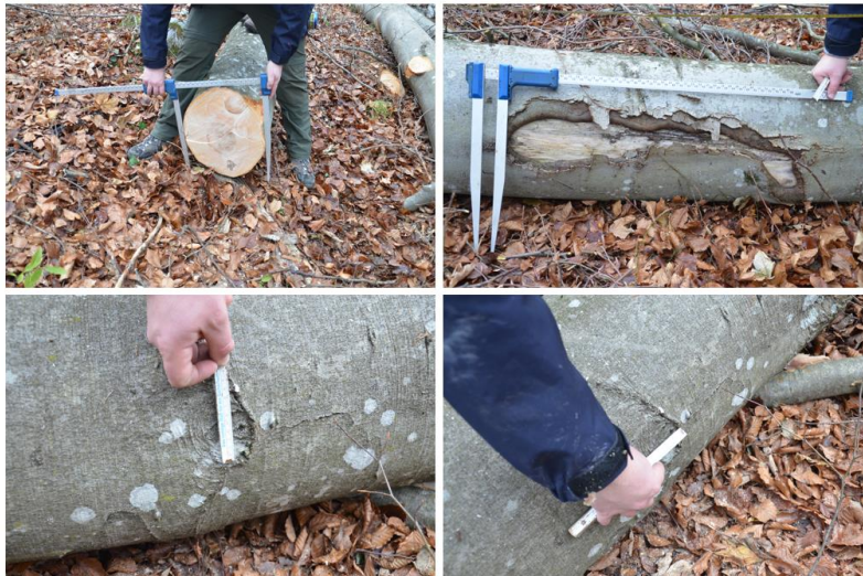
Slika 3: Primeri meritev lastnosti in napak sortimentov.
