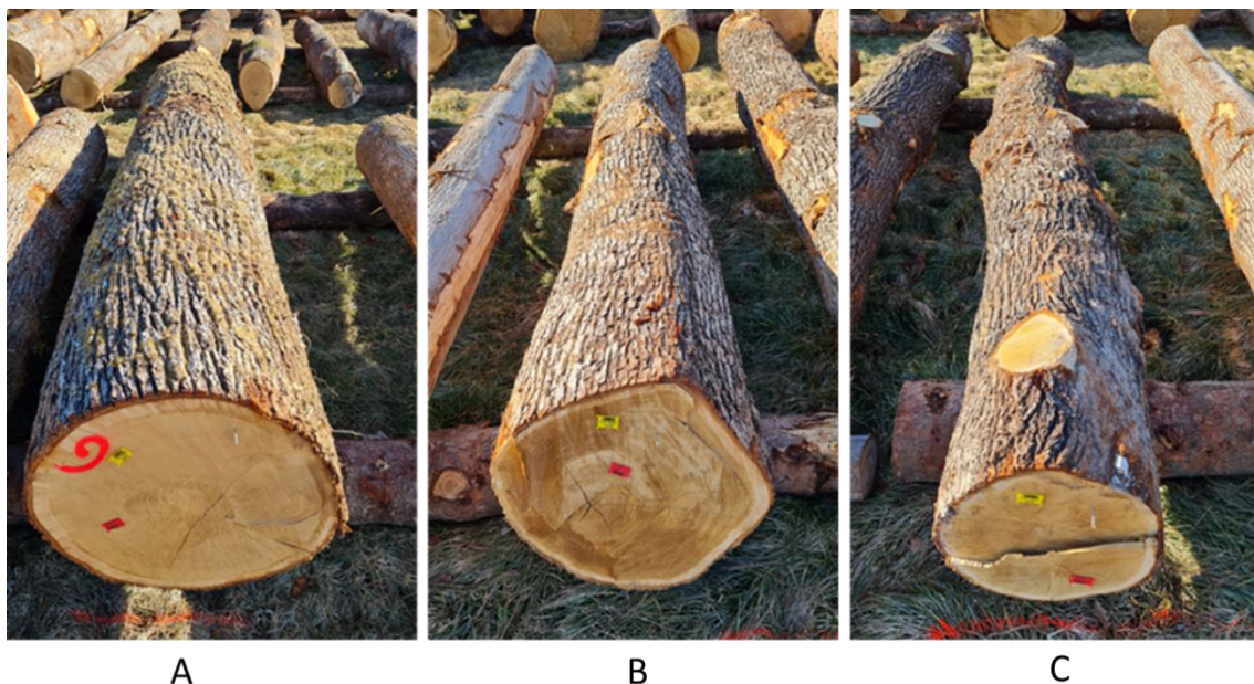
Slika 1. Vizualno razvrščanje hrastove hlodovine v kakovostne razrede (Pravilnik..., 2017): A – furnirska hlodovina izjemne kakovosti, B – žagarska hlodovina 1. kakovosti, C – žagarska hlodovina 2. kakovosti.
