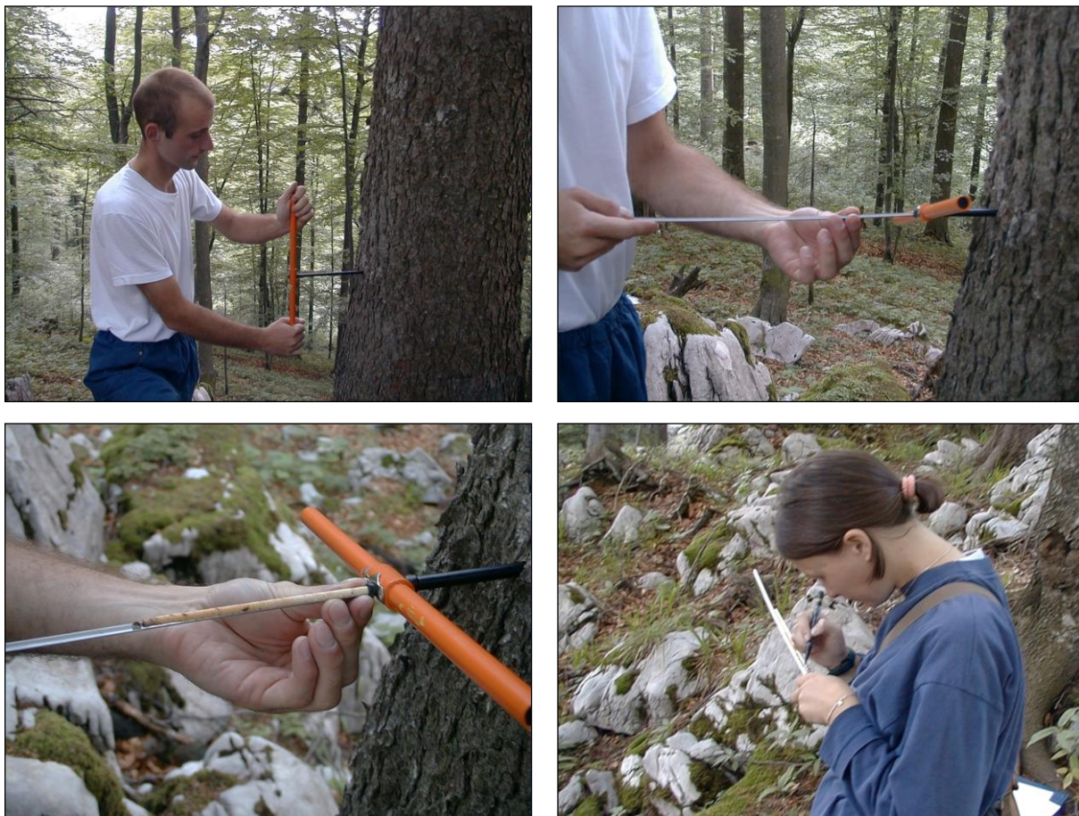
Slika 14: Odvzem izvrtka s prirastoslovnim svedrom (od levo zgoraj proti desno spodaj): Vrtnanje v drevo, vstavljanje vlečke, izvlek izvrtka, vstavljanje v plastično slamico
