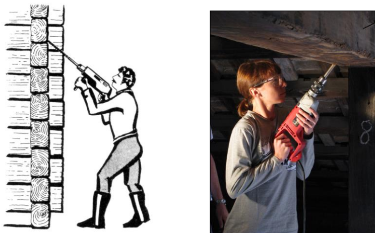
Slika 15: Odvzem vzorcev suhega lesa (shematsko in »v živo«).
