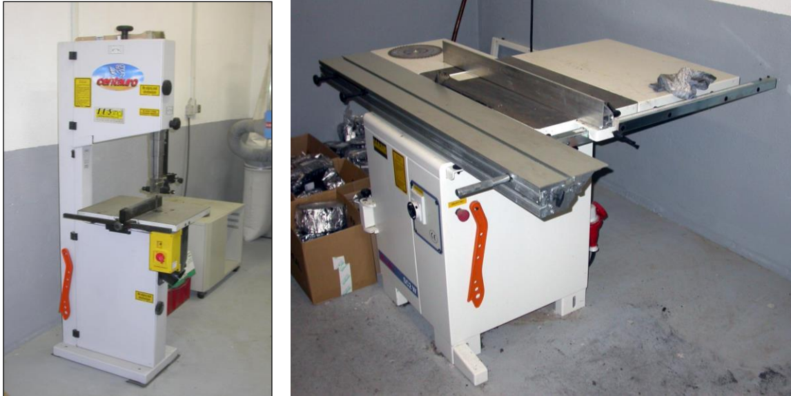
Slika 34: Tračna žaga (levo) omogoča žaganje večjih kosov lesa do debeline 24 cm. Primerno stanjšane se jih do konca obdela na krožni žagi (desno).
