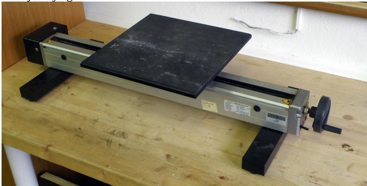
Slika 20: Merilna mizica LINTAB – tipična predstavnica modernih ročnih merilnih miz.
