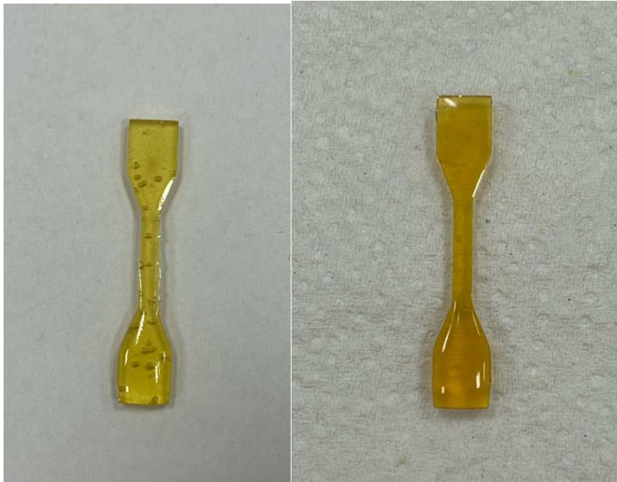
Slika 13: a) Neuspešno zamrežena čista epoksidna smola, b) Uspešno zamrežena sintetizirana epoksidna smola
