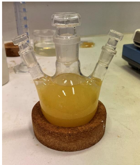
Slika 9: Spiranje z vodo – ločene plasti
