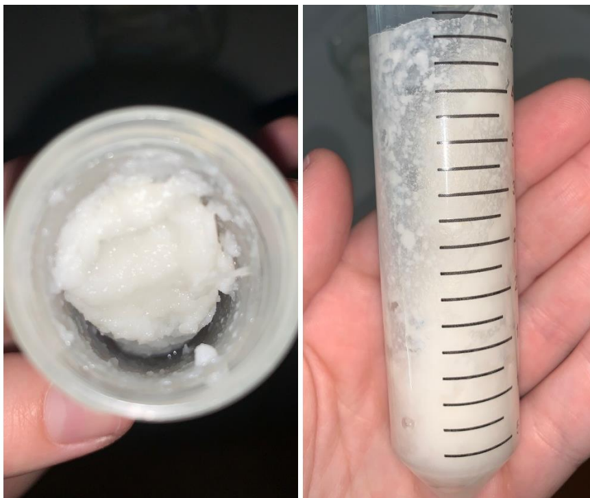
Slika 18: Produkt sinteze poliHIPE 6 z 1 % celuloze
