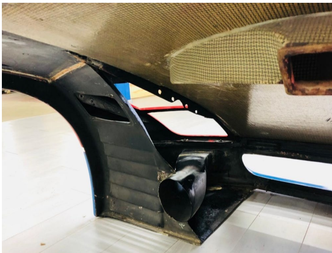
Slika 1: Kompozit aramidnih vlaken in smole avtomobila Ferrari F40 [7]
