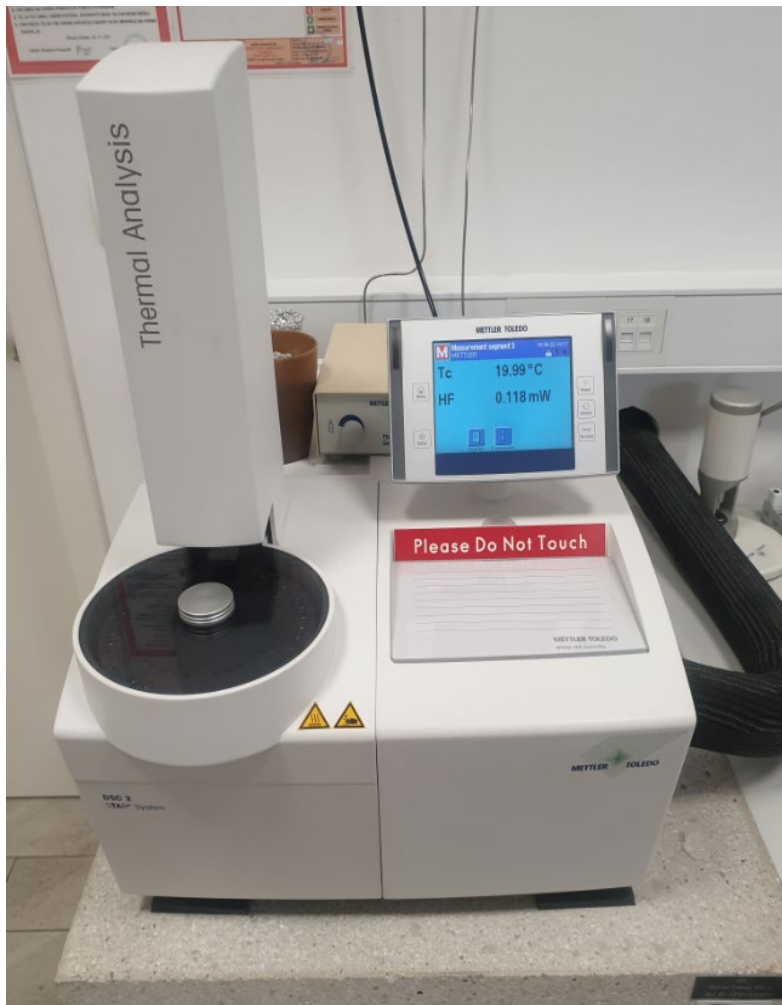
Slika 6: DSC naprava v laboratoriju Fakultete za tehnologijo polimerov
