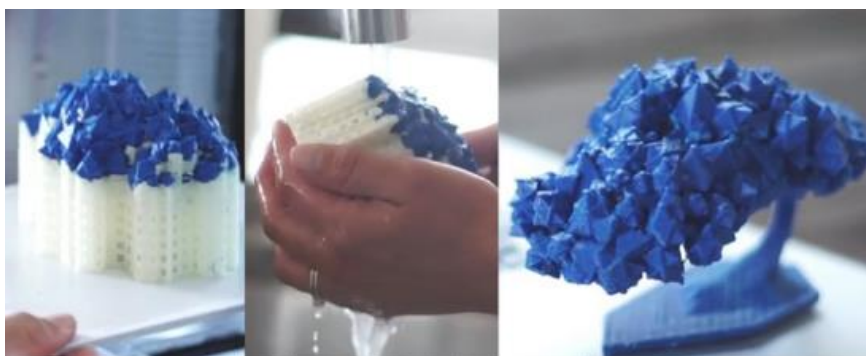
Slika 11: Primer postavitve podpor in njihovo odstranjevanje [12]
