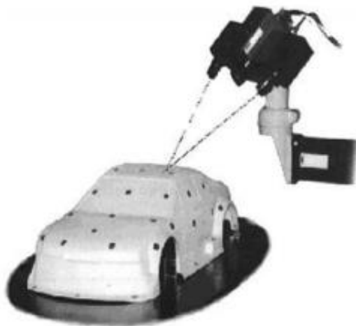
Slika 3: Prikaz pridobivanja podatkov s skenerjem [5]
