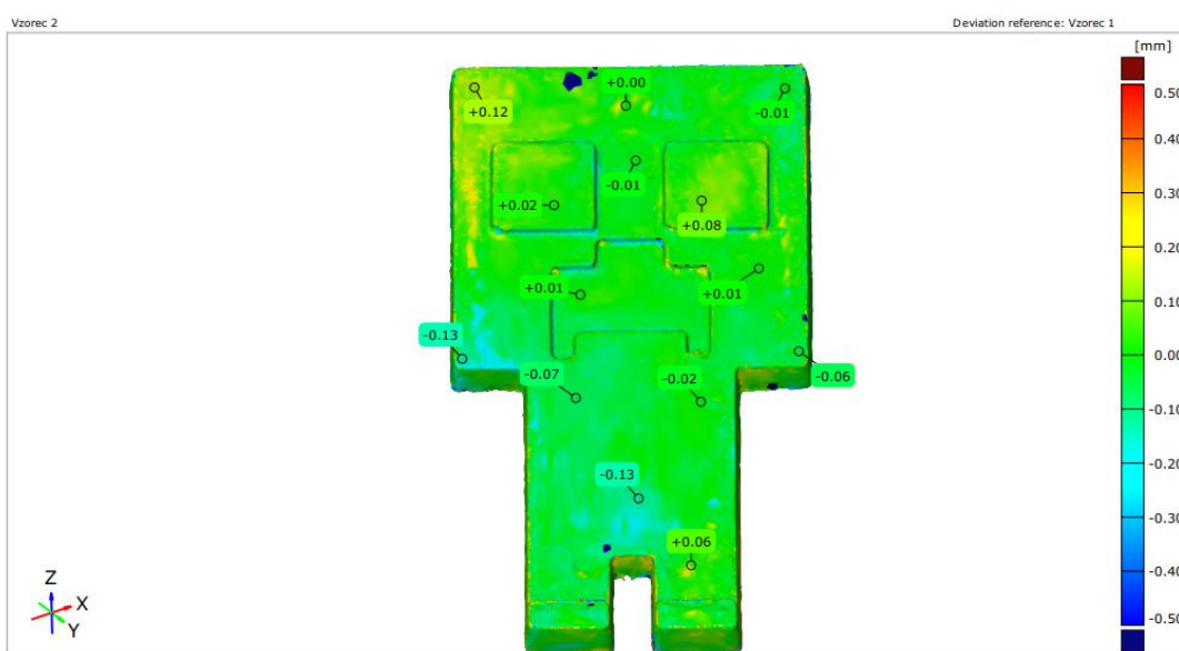
Slika 29: Površinska primerjava vzorcev 1 in 2 – orodni vložek polikarbonat
