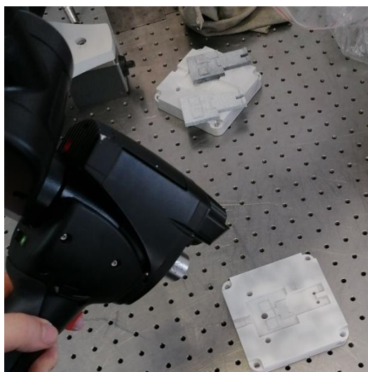
Slika 16: Laserski skener z merilno roko podjetja Hexagon
