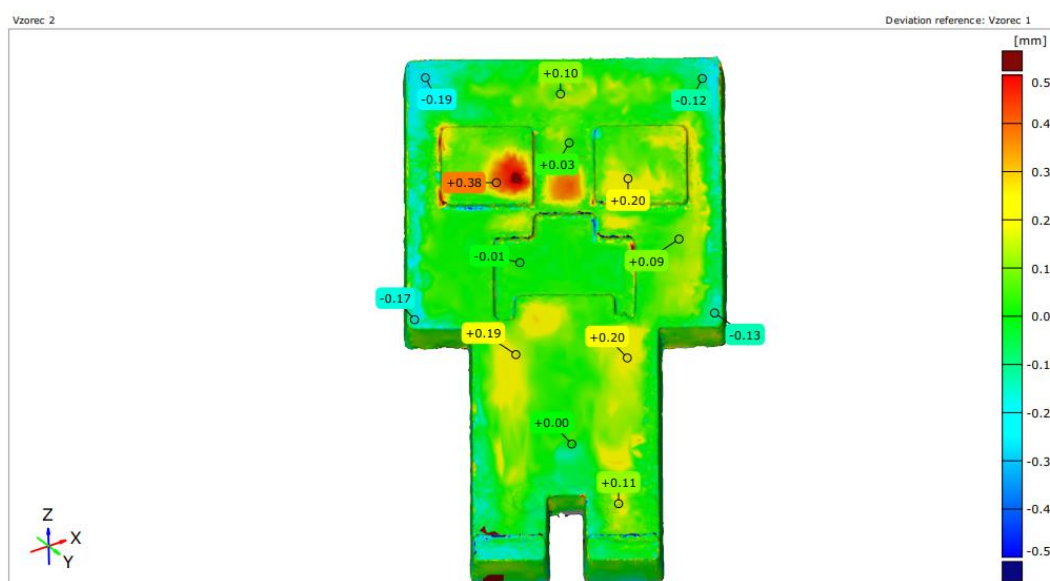
Slika 31: Površinska primerjava vzorcev 1 in 2 – orodni vložek Perform TH
