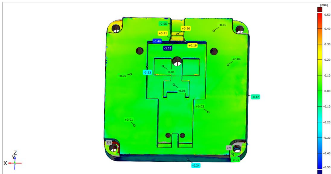
Slika 40: Primerjava orodnih vložkov CAD osnovni in sken za Perform TH
