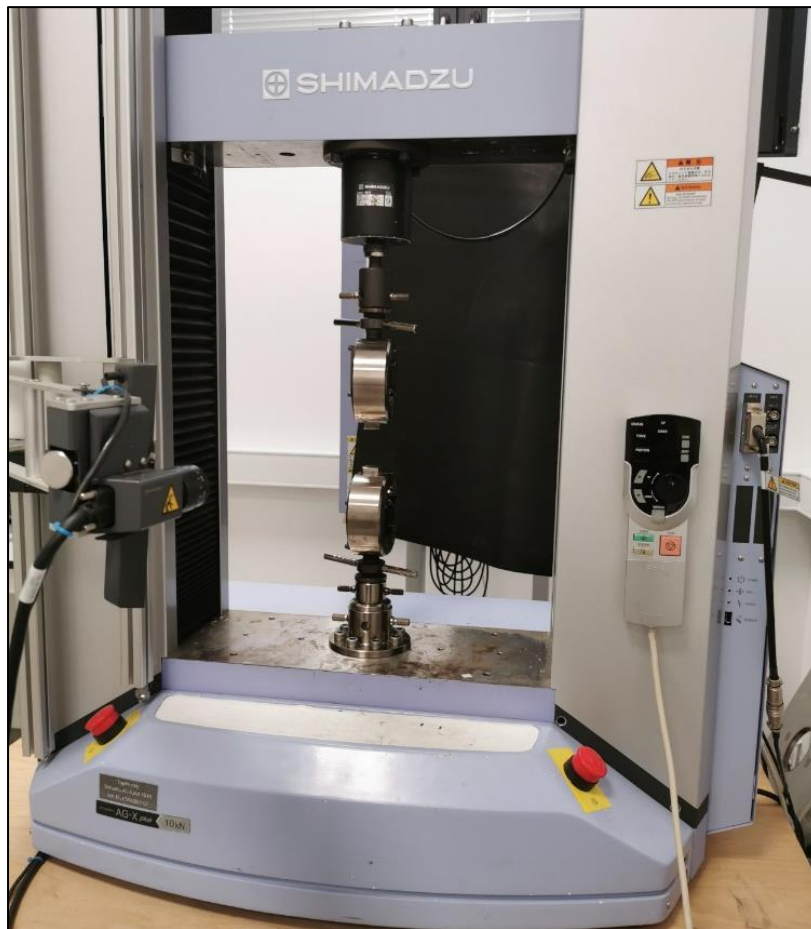
Slika 18: Trgalni stroj s čeljustmi za natezni test
