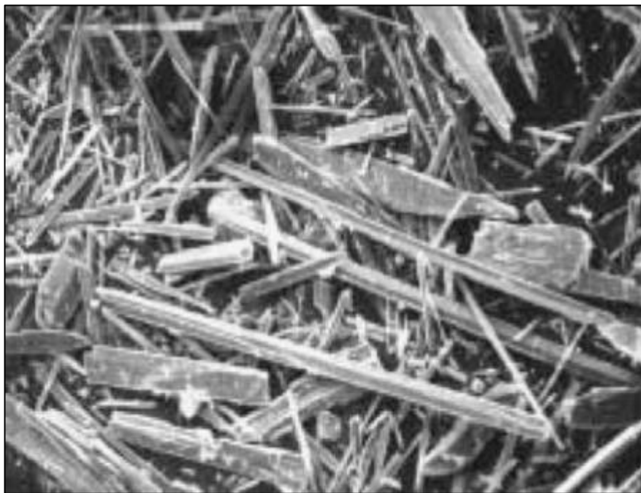
Slika 3: Iglíčasta struktura volastonita pod 170-kratno povečavo [6]
