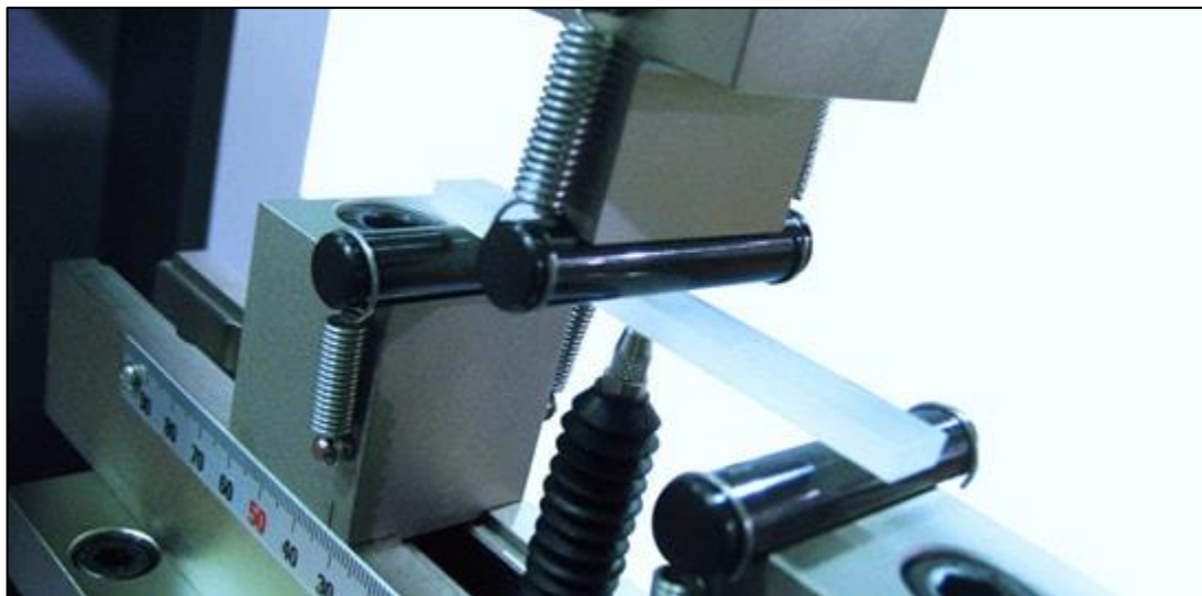
Slika 19: Podpore za upogibni test [16]
