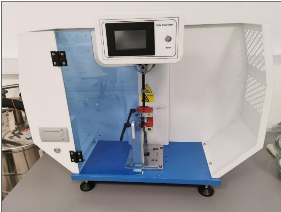
Slika 20: Naprava za testiranje udarne žilavosti LIYI LY-XJJD5
