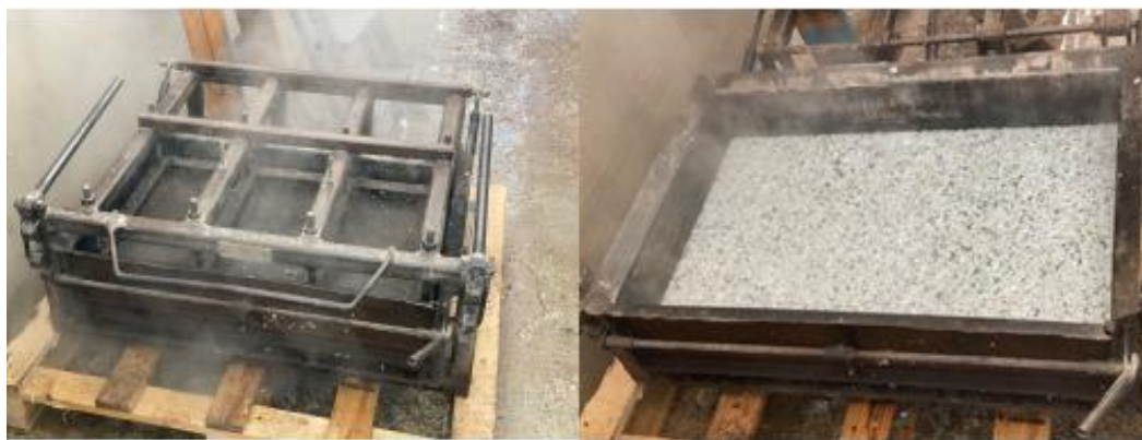
Slika 16: Levo: orodje v fazi aktivacije veziva s pomočjo vroče pare, desno: odprto orodje z oblikovanim kompozitom
