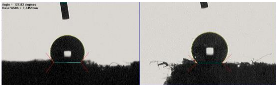
Slika 40: Meritve kontaktnega kota tekstila (primera s stabilno kapljico)
