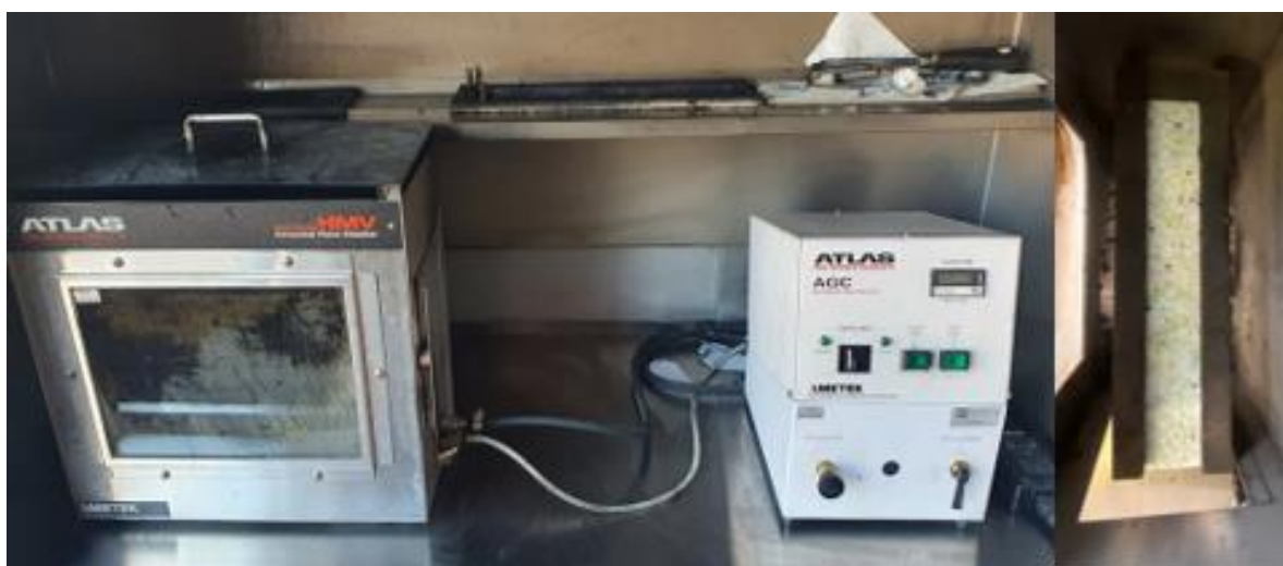
Slika 19: Levo: Atlas HMV Horizontal Flame Chamber, desno: vzorec, nameščen na podporni element z držalom v obliki črke U
