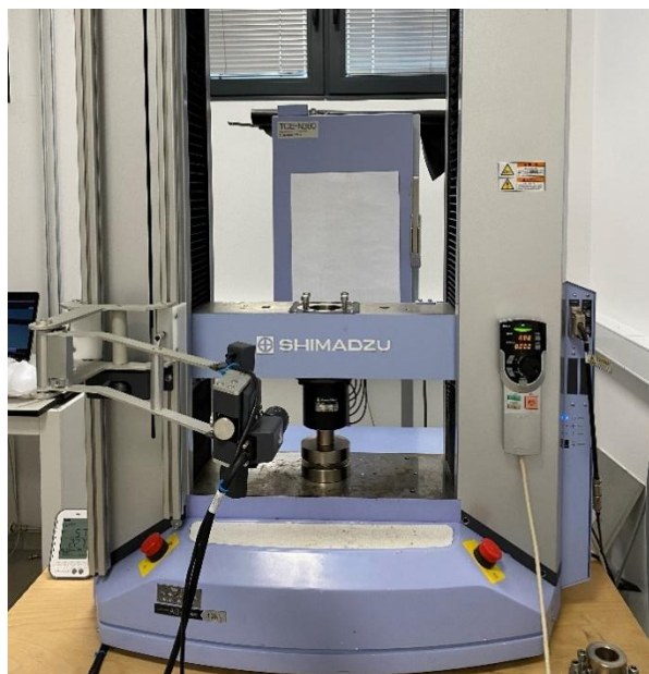
Slika 18: Univerzalni stroj Shimadzu AG X plus, ki je poleg nateznega preizkusa primeren tudi za izvajanje tlačnega in preizkusa
