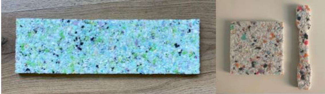
Slika 17: Fotografije preizkušancev za karakterizacijo (levo: za preizkus gorljivosti, sredina: za preizkus tlačne trdnosti, desno: za preizkus natezne trdnosti)
